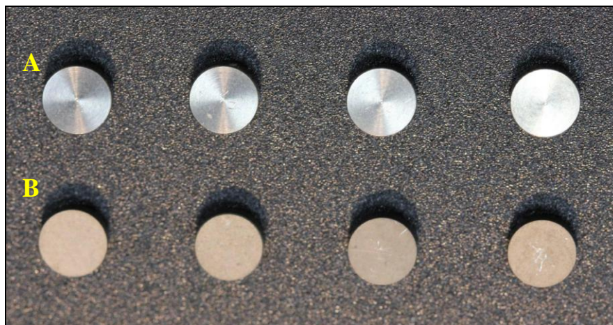
Fig. 17 - Placas de Ti lisas (A) e rugosas (B).
