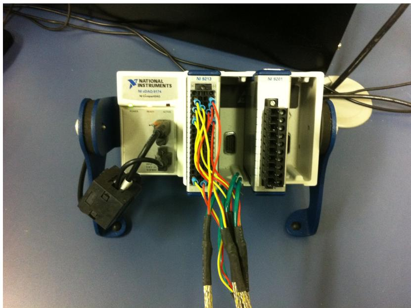
Figura I.6: Módulo de aquisição de sinais.
