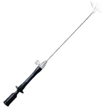
(b) Eletrodo com conjunto de termistores (AngioDynamics, USA).
