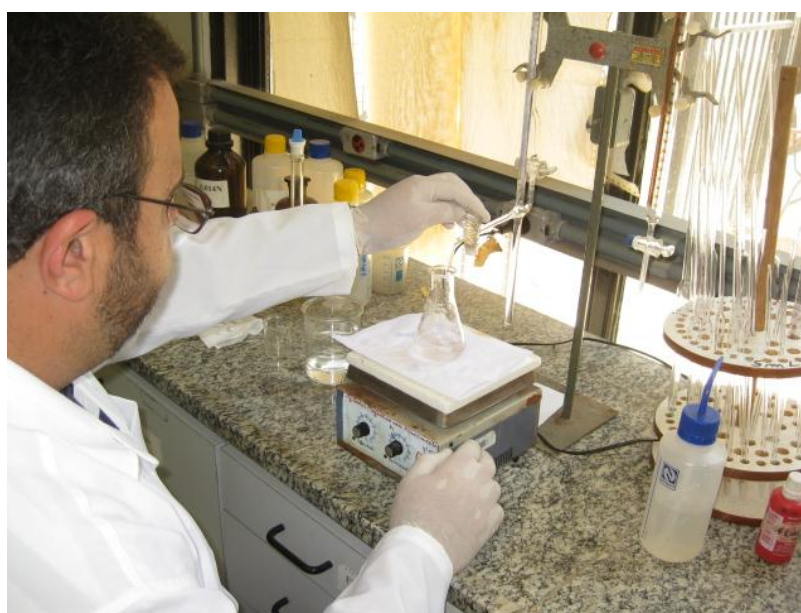
Figura 2.15 - Determinação de \text{CO}_2 livre por meio de titulação.
