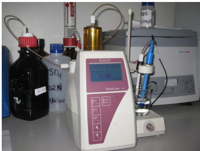
Figura 2.14 - Vista frontal do titulador automático.
