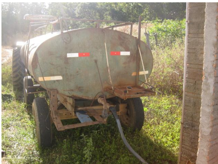
Figura 2.9 - Tanque utilizado para transporte da solução usada nos ensaios de traçador.
