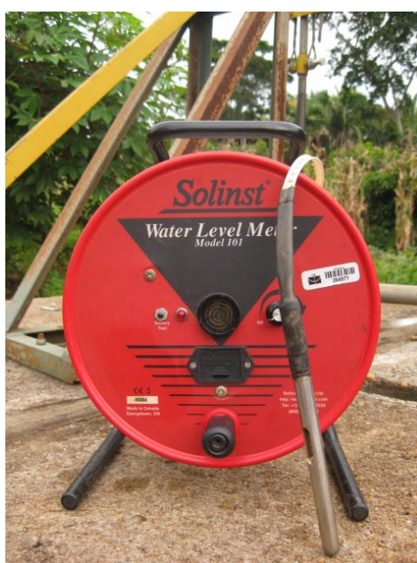
Figura 2.12 - Detalhe do medidor de nível elétrico/manual com sensor acústico.
