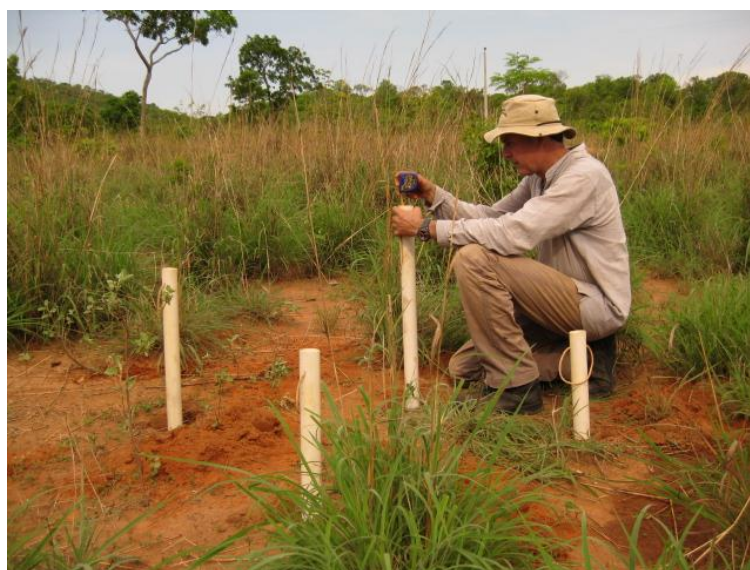
Figura 2.11 - Ilustração da execução do ensaio de infiltração in situ pelo método open end hole .
