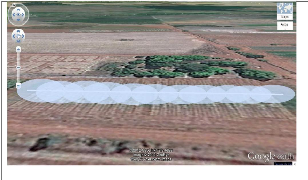
Figura 2.2. Esquema representativo do sistema line source, no qual é possível observar o raio de alcance dos aspersores.
