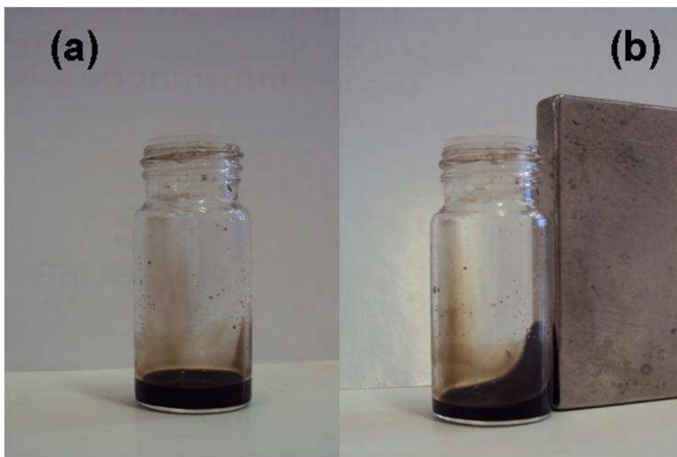
Figura 44. Imagens do LIM obtido em (a) na ausência e (b) na presença de magneto de Nd.
