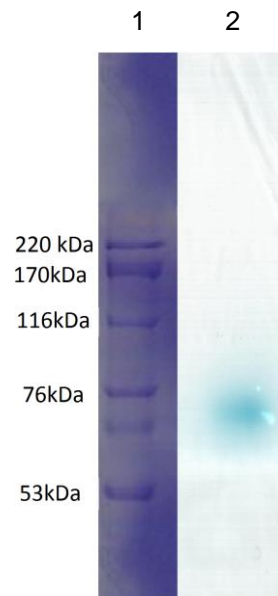
Figura 13: Zimograma para atividade da \beta -galactosidase revelado com X-Gal. Linha 1: padrões de massa molar conhecido. Linha 2: banda proteica de aproximadamente 75 kDa com atividade enzimática característica da enzima \beta -galactosidase na presença do substrato X-Gal.
