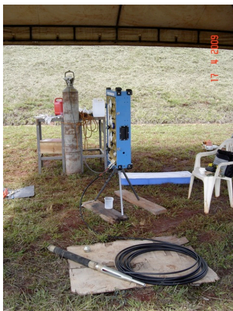
Figura 2.1 - Ilustração do pressiômetro tipo Ménard (MPM)
