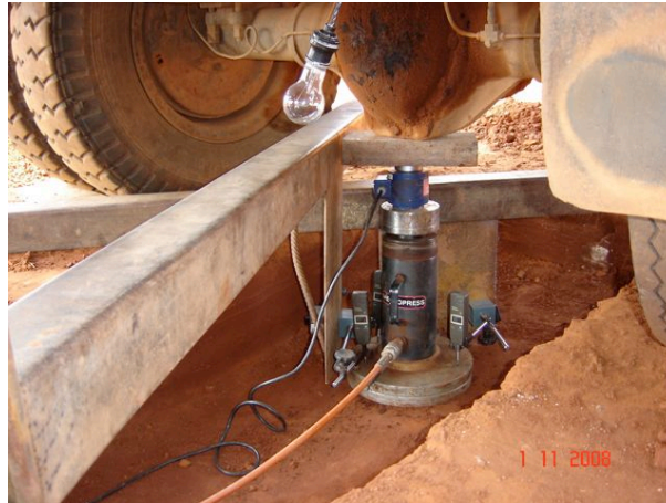
Figura 2.12 – Esquema de montagem do ensaio de placa.
