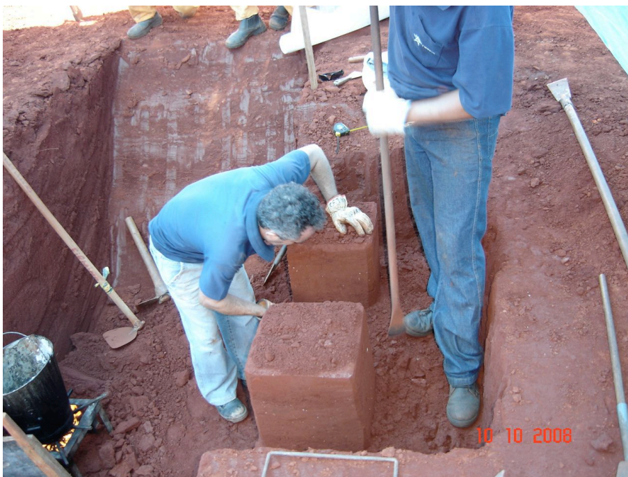
Figura 3.7 - Retirada dos blocos de amostra indeformada.
