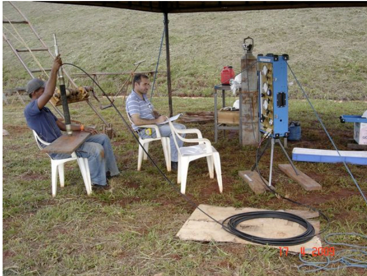
Figura 3.20 - PMT - Calibração da sonda ao ar livre.
