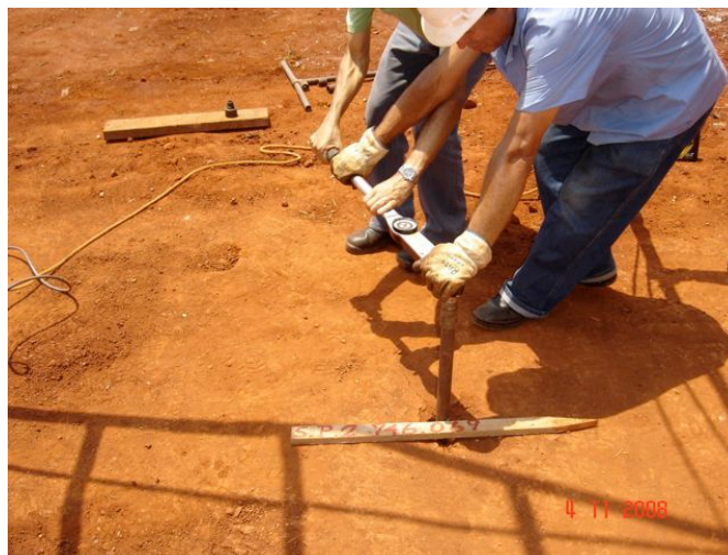
Figura 2.11 - Ensaio de medição do torque sendo realizado.
