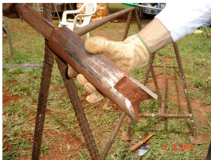
Figura 3.22 - Detalhe do trado após retirada do furo.
