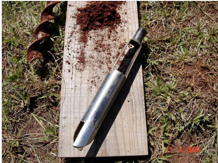
Figura 3.21 - Detalhe do trado utilizado.
