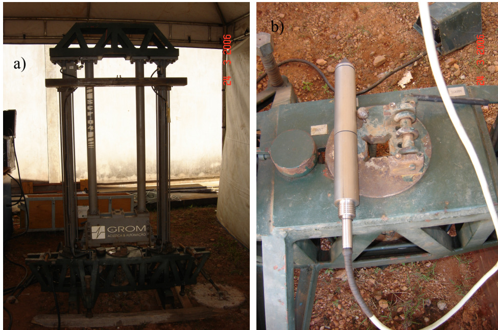
Figura 2.8 - Sistema de cravação do cone elétrico de FURNAS Centrais Elétricas S.A. a) Equipamento hidráulico de cravação de capacidade de 10 kN.; b) Cone elétrico.
