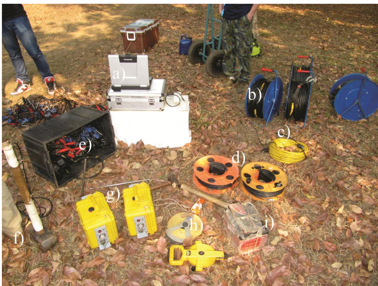
Figura 3.6 Equipamento para aquisição de Sísmica de Refração. a) computador; b) cabos para conectar os geofones; c) cabo para conectar o módulo de aquisição ao computador; d) cabo para conectar módulo de aquisição à marreta; e) Geofones; f) marreta de oito quilogramas; g) módulo de aquisição; h) trenas de 50 e 100 metros; i) Bateria 12Volts.
