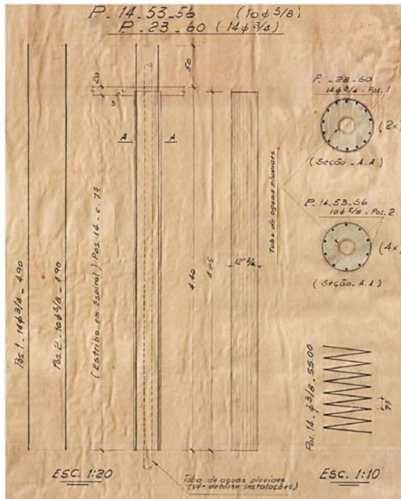
i) Armação típica de pilar com tubo de águas pluviais
