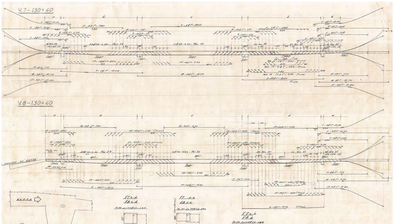
Figura 61.b Armação de vigas da primeira laje e vínculo com as colunas Fonte: Acervo do Arquivo Público do Distrito Federal
