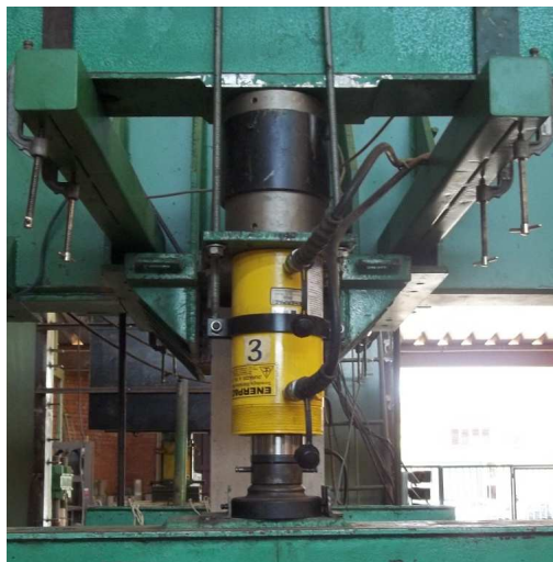
Figura 3.9.9 - Célula de carga em conjunto com o atuador hidráulico
