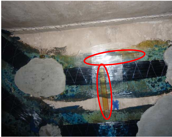
Figura 3.8.22 - Extensômetros colados na parte inferior do modelo de laje LC-S2.
