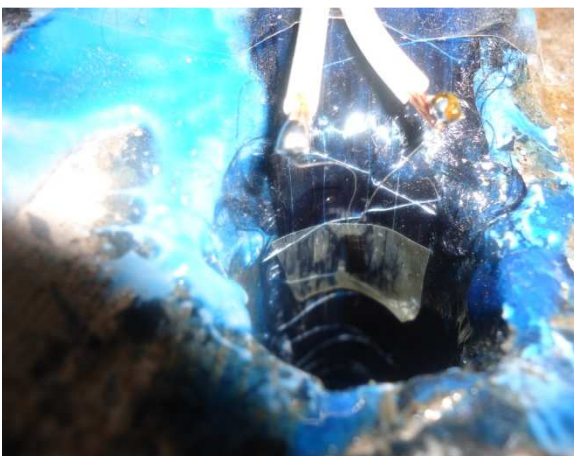
Figura 3.8.16 - Extensômetros devidamente colado no reforço
