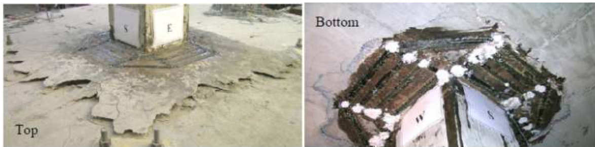
Figura 2.5.7 - Modelo de reforço do tipo costura, WIDIANTO (2006)
