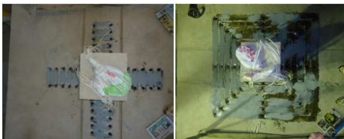
Figura 3.4.9 - Modelos LC-S1 e LR-S após aplicação do MBrace putty
