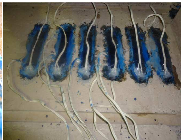
Figura 3.8.17 - Proteção de silicone nos extensômetros do modelo LC-S1
