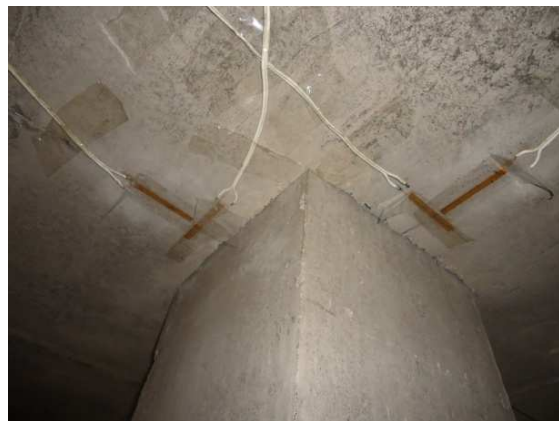
Figura 3.8.21 - Extensômetros colados na parte inferior do modelo de laje L0-01.
