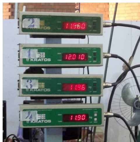
Figura 3.9.10 - Indicadores digitais utilizados para leituras das cargas a cada passo de carga
