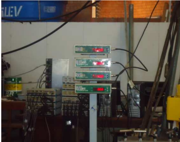
Figura 3.9.1 - Sistema de controle visual de cargas
