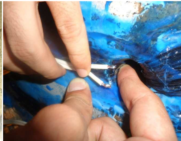
Figura 3.8.15 - Colagem do extensômetro na superfície do PRFC
