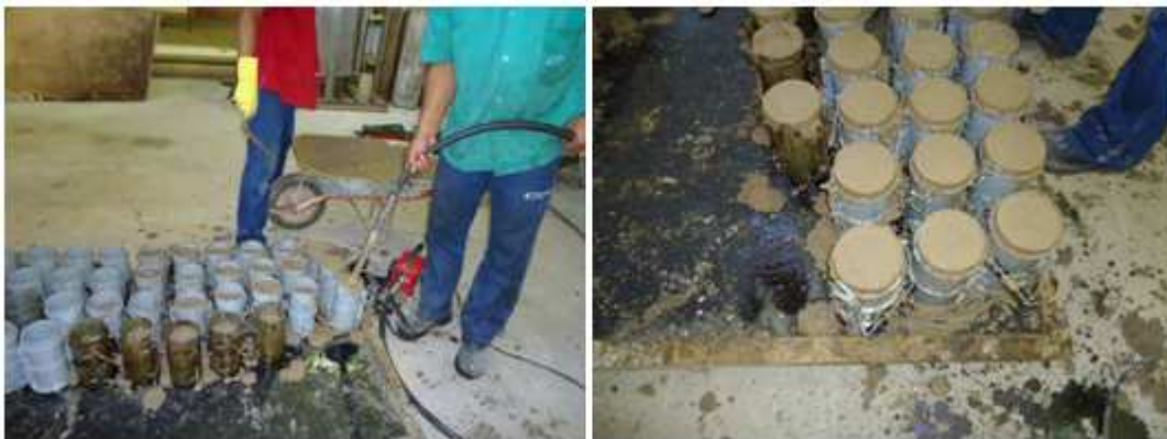
Figura 3.7.2 - Moldagem dos corpos de prova
