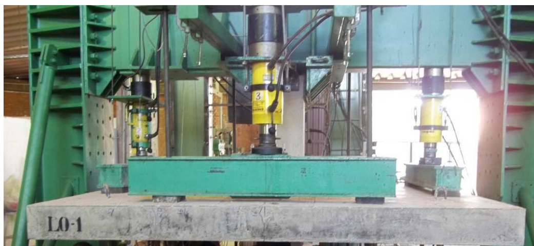
Figura 3.9.8 - Viga de reação e atuador hidráulico
