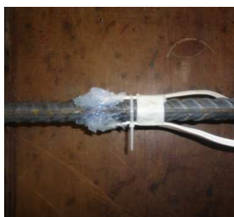
Figura 3.8.7 - Barra após aplicação do silicone
