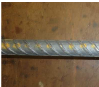
Figura 3.8.3 - Barra de aço antes da instrumentação.
