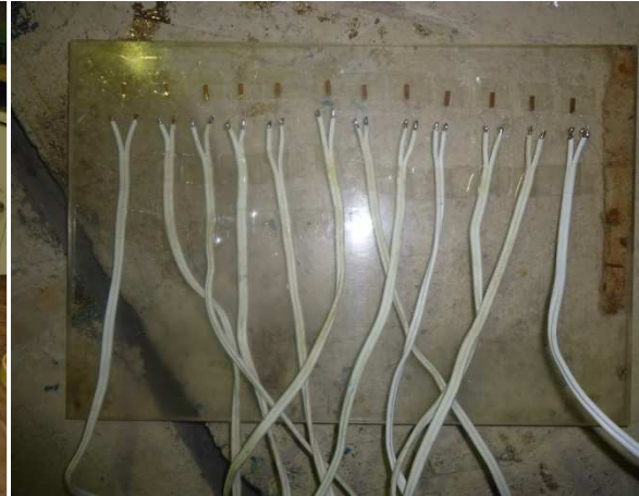
Figura 3.8.13 - Extensômetros a serem colados na armadura de cisalhamento
