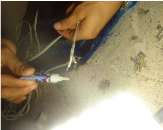
Figura 3.8.14 - Aplicação de adesivo epóxico no extensômetro
