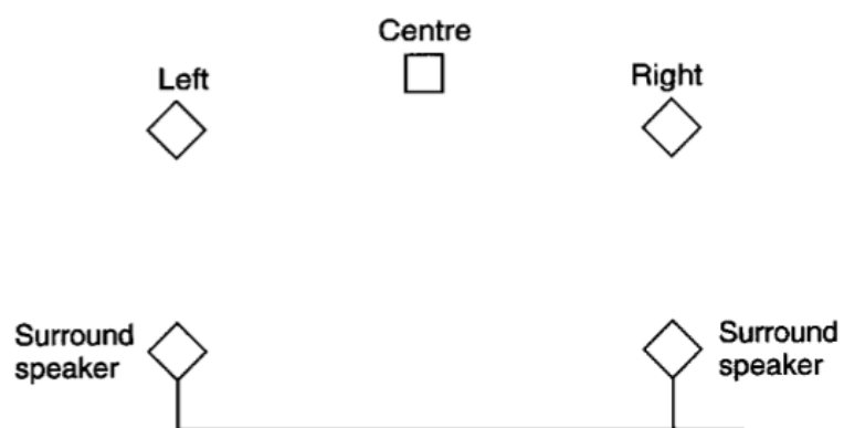
Figura 2.8: Arranjo dos alto-falantes no esquema Dolby surround 5.1, com 5 canais e um subwoofer . Fonte: The Art of Sound Reproduction [22]
