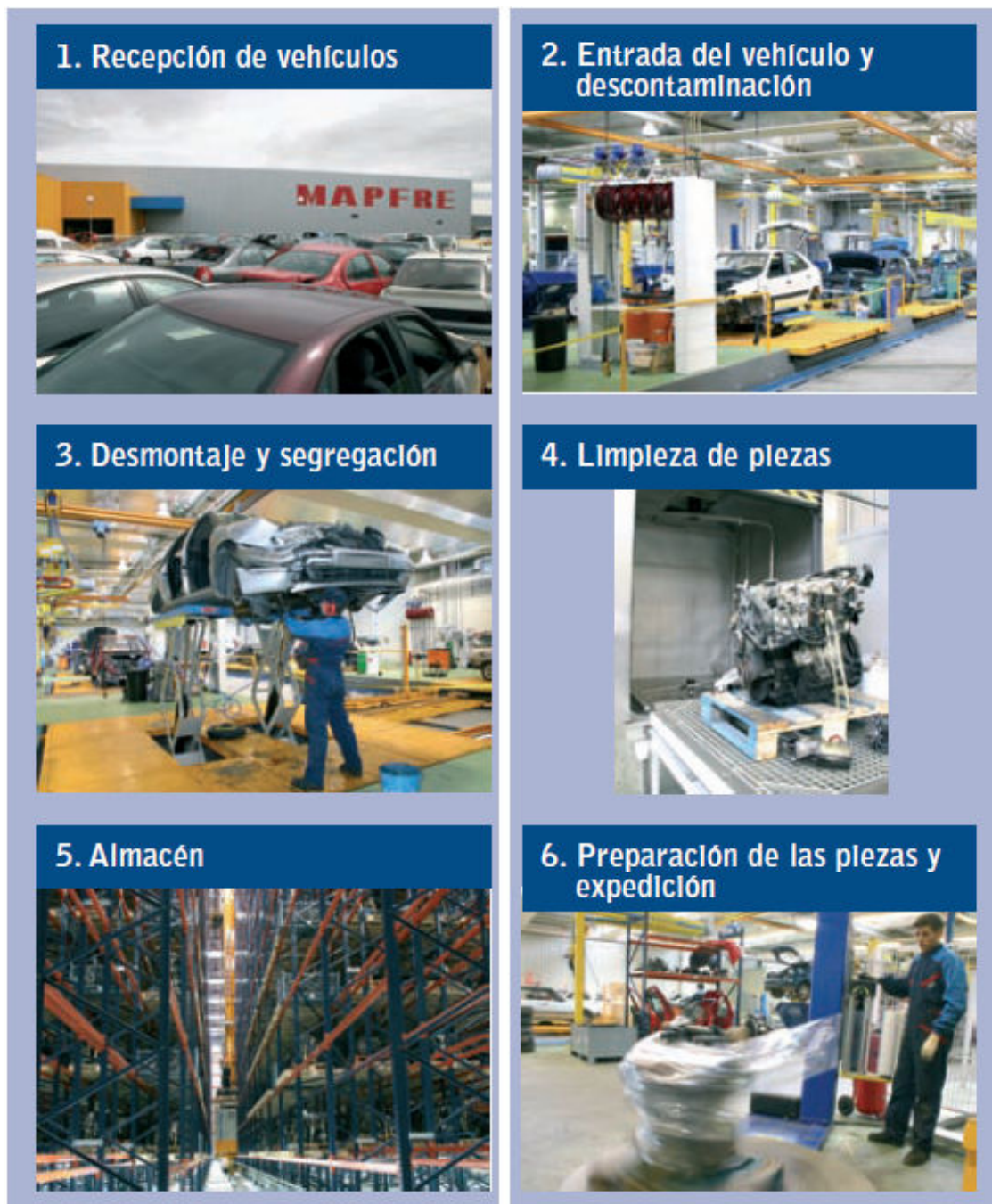
Figura 4.1: Ilustração das etapas de funcionamento de um CAT.
