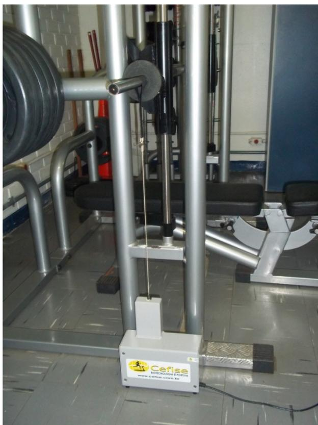
Figura 5 – Potenciômetro conectado à barra da máquina smith.
