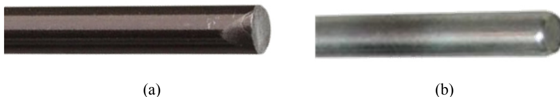
Figura 3.2 – Superfície do fio de Ni-Ti (a) oxidada (b) decapada com reagente Kroll.
