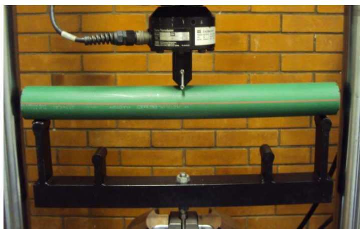
Figura 3.18 – Ensaio de flexão em três pontos do tubo de PP na MTS.
