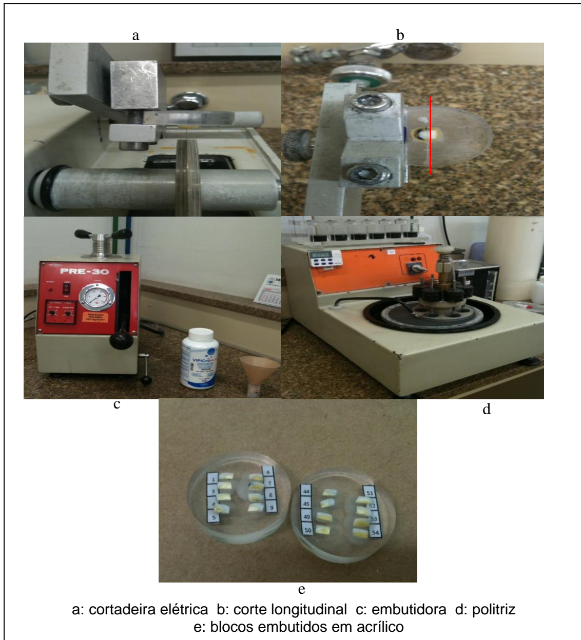
Figura 09 – Preparo dos blocos para avaliação da dureza longitudinal
