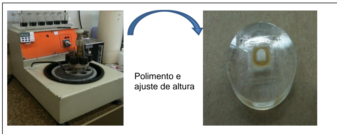
Figura 2 – Polimento com auxílio da politriz
