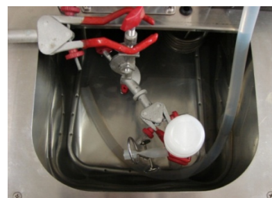
Figura 34. Esquema de células Franz-type e célula montada no laboratório. O sistema de difusão em si (A), visão do encaixe do sistema de difusão no banho térmico (B), visão do banho térmico contendo o sistema de difusão (C), adaptação para o agitador magnético não sofrer danos por estar imerso na água do banho térmico (D), visão superior do banho térmico (E).
