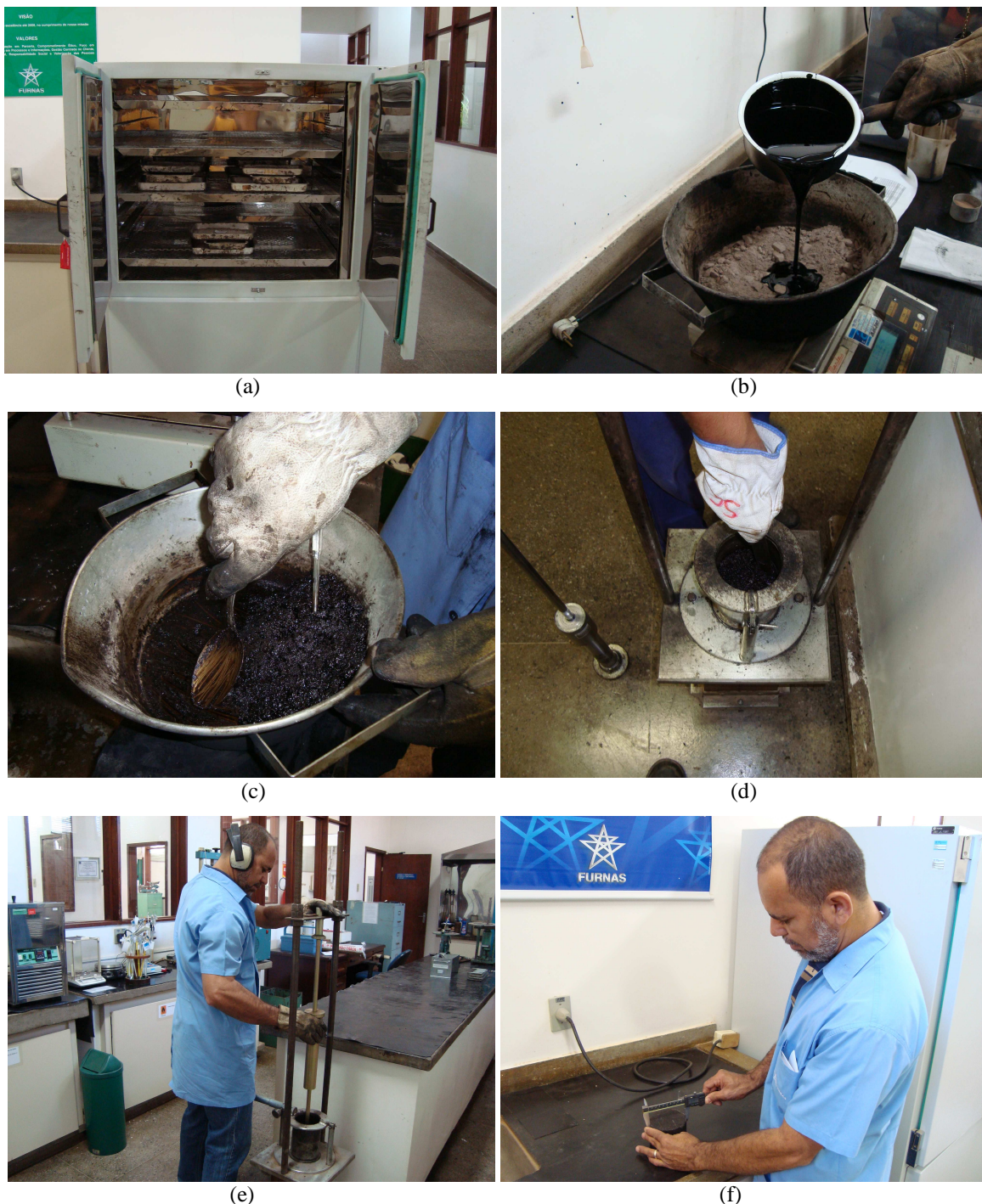
Figura 4.2 Sequência da Moldagem dos Corpos-de-prova – Compactação Manual:
