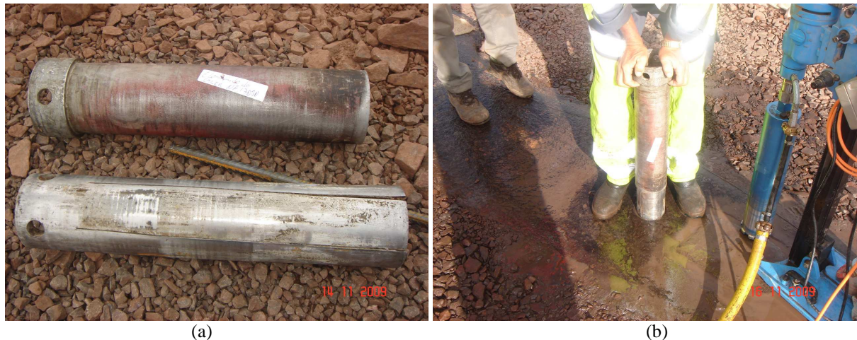
Figura 3.39 Extrator Utilizado para Retirar os Testemunhos dos Furos: a) Detalhes das Partes, b) Detalhe da Utilização na Retirada dos Testemunhos.
