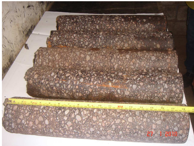
Figura 3.40 Testemunhos Extraídos das Camadas 70 e 71.
