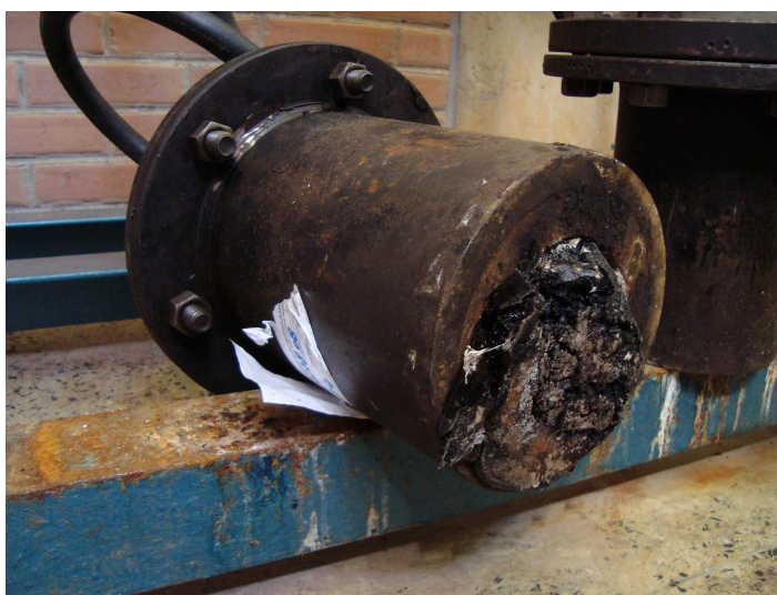
Figura 4.8 Detalhe da Deformação do Corpo-de-prova na Base da Campânula.
