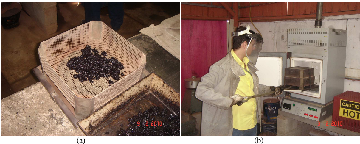
Figura 3.38 Equipamento Utilizado para a Determinação do Teor de CAP: a) Detalhe da Amostra na Cesta, b) Vista Geral do Equipamento.
