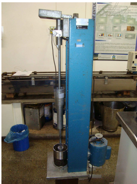
Figura 4.4 Soquete Mecânico Utilizado na Compactação das Misturas com Diferentes Fíleres.
