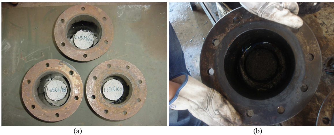
(a) (b) Figura 4.7 Montagem dos Corpos-de-prova na Campânula: a) Corpo-de-prova dentro da Campânula Aguardando Material Selante; b) Corpo-de-prova dentro da Campânula com Material Selante.
