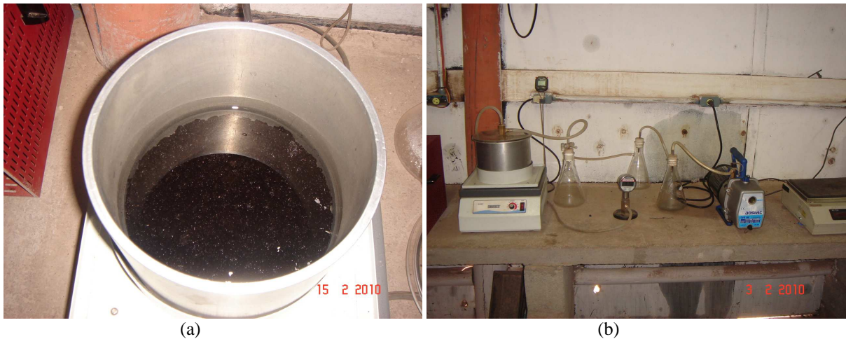
Figura 3.37 Equipamento Utilizado para a Determinação da Massa Específica Máxima: a) Detalhe do Recipiente de Metal com a Amostra Antes do Ensaio, b) Vista Geral do Equipamento.
