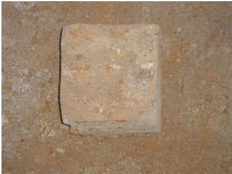
Figura 4.9 – Amostra de bloco indeformado para ensaios geotécnicos do horizonte Cf RQ11.
