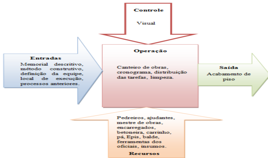
Figura 5.12 – Fluxo do processo na execução de acabamento de piso
