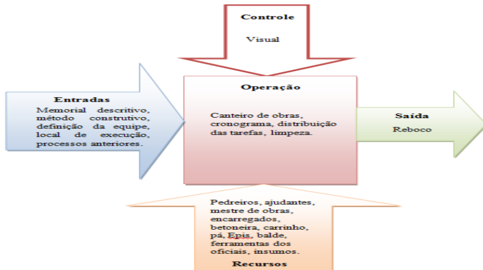
Figura 5.7 – Fluxo do processo de execução do reboco
