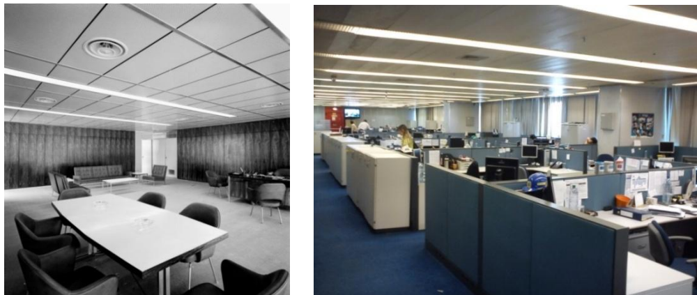
Figura 120 – Usos originais e usos atuais do Sede I – salas originalmente compartimentadas por divisórias foram substituídas por salões com estações de trabalho em todos os pavimentos- tipo. A estrutura independente possibilitando a diversidade de uso e a adaptação a novos tempos. Fotos: à esquerda, Marcel Gautherot (1960) /Acervo IMS; à direita: JWL (2012).
