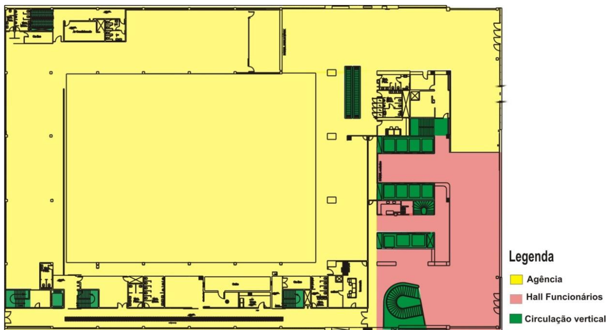
Figura 78 – Esquema funcional do térreo, onde se observa a independência espacial da Agência Central e a caracterização dos acessos. Desenho nosso sobre planta de Garcia Roza.
