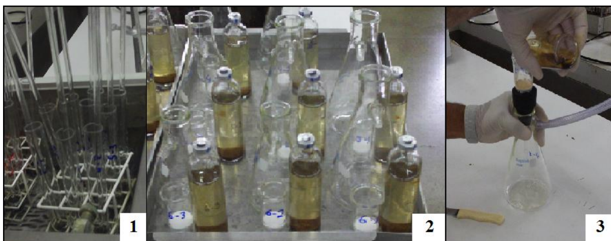
Figura 17 - Etapas da separação da lignina. A foto 1 mostra a hidrólise ácida a 72% de H_2SO_4 . A foto 2 mostra os frasco para autoclavagem com H_2SO_4 a 4%. A foto 3 mostra a filtragem da lignina após processo de autoclave (fotos do autor, 2012)
