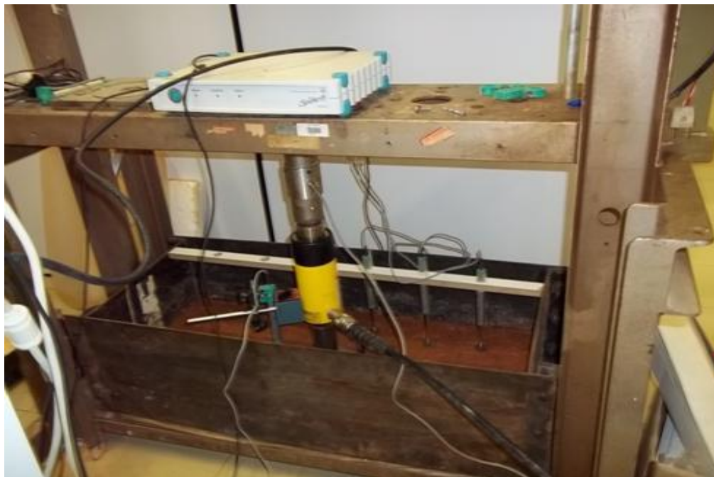
Figura 3.13 – Instrumentação de medidas das deformações.
