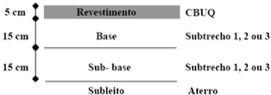
Figura 3.8 – Estrutura do pavimento do Trecho 2 (Rezende, 2003).
