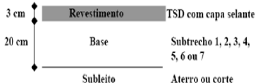
Figura 3.7 – Estrutura do pavimento do Trecho 1 (Rezende, 2003).
