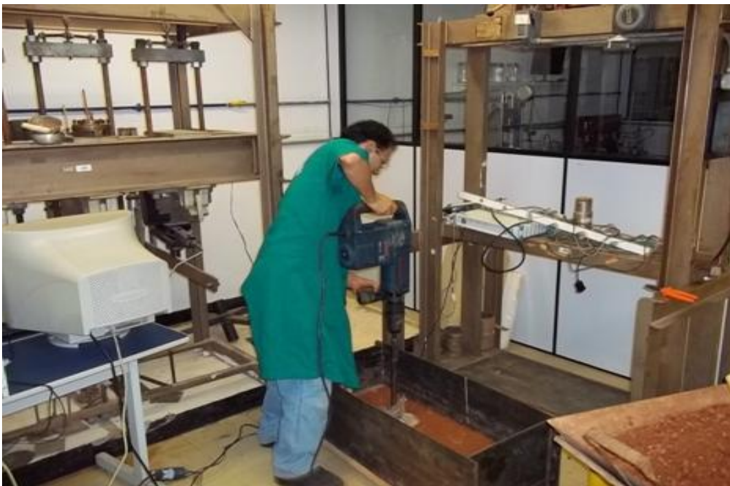
Figura 3.12 – Procedimento de compactação do solo.
