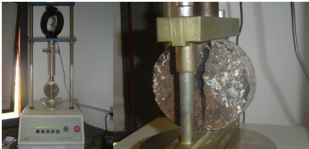
Figura 3.15 – Equipamentode Ensaio de Resistência à Tração no CBUQ (Trecho 2).
