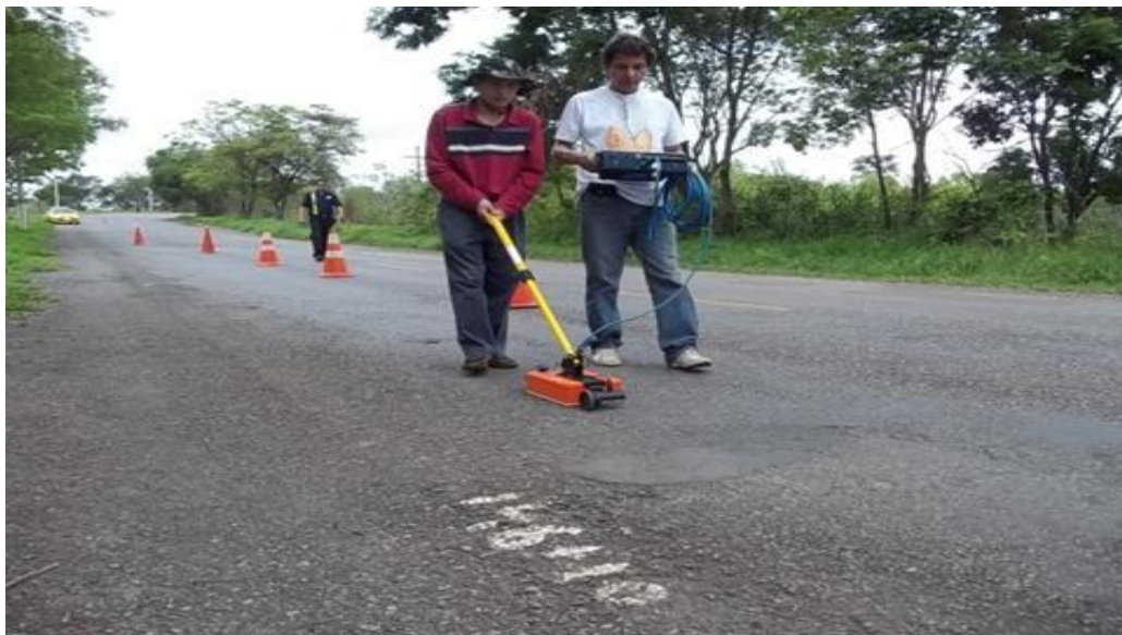
Figura 3.19 – Ensaio de GPR (Trecho 1).
