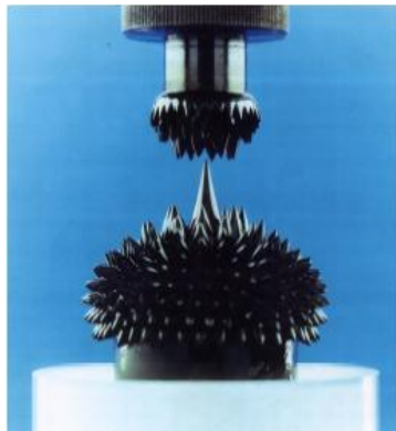
Figura I-1: Resposta macroscópica a aplicação de um campo magnético sobre um fluido magnético
