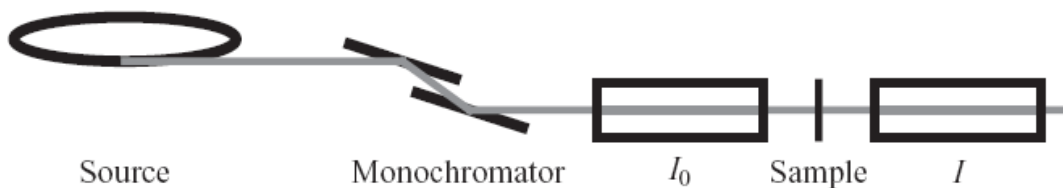
Figura II-5: Esquema de montagem de experimentos de absorção de raios-X.
