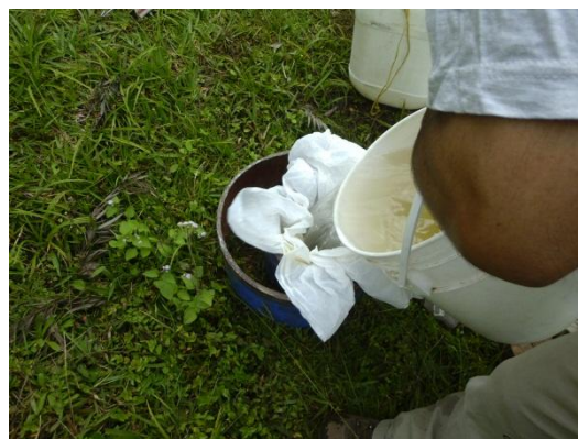
Figura 4.9 – Enchimento dos anéis com água
