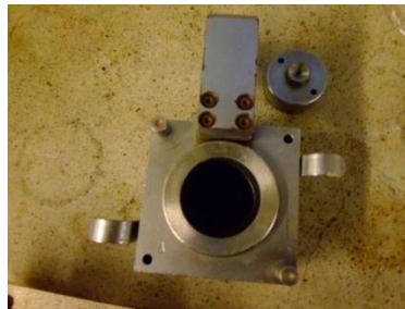
Figura 4.15 - Montagem da caixa de cisalhamento
