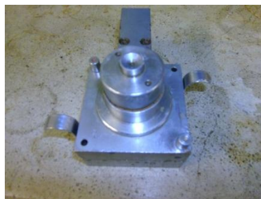
Figura 4.16 - Extração do corpo de prova para a caixa de cisalhamento
