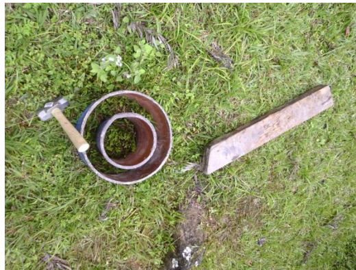
Figura 4.8 – Materiais utilizados no ensaio (martelo, anéis, tábua).
