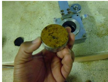
Figura 4.14 - Moldagem do corpo de provas
