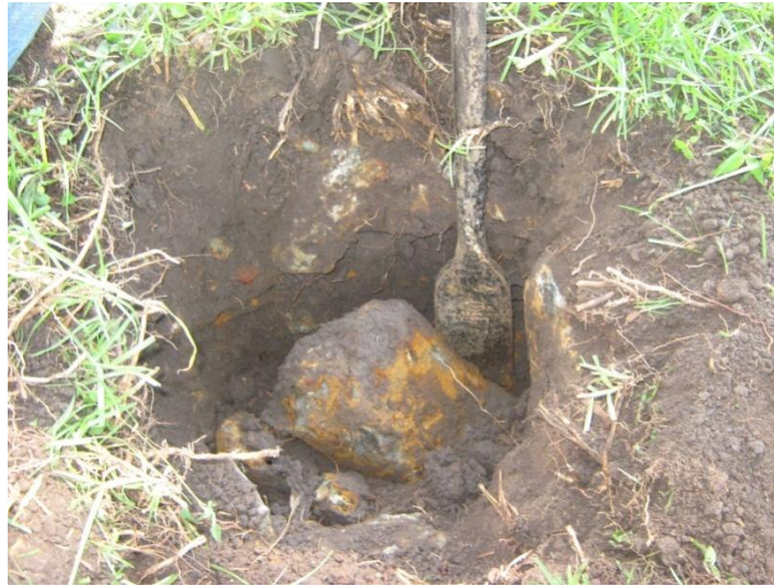
Figura 4.6 - Dificuldade na amostragem devido à presença de blocos de pedra
