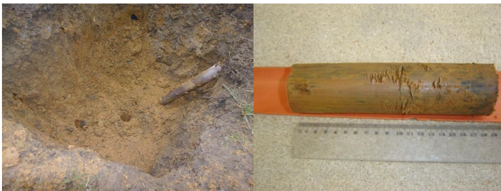
Figura 4.7 - Amostra recém extraída em campo e posteriormente extraída do tubo em laboratório.
