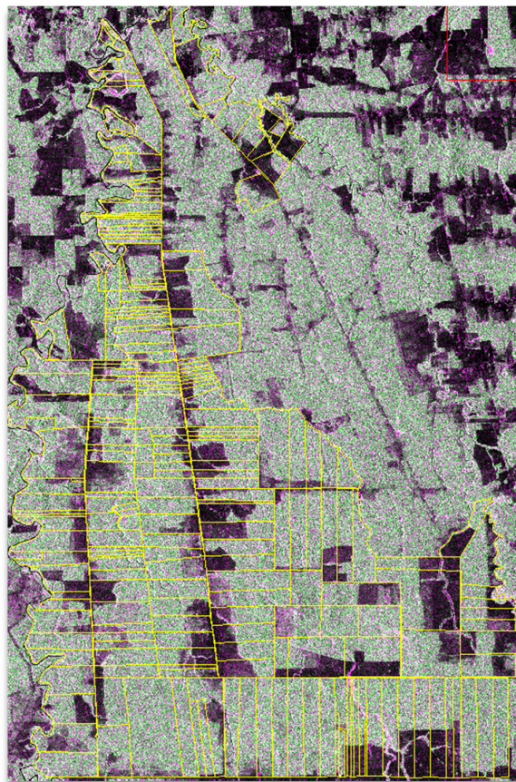
Figura 4.3. - Sobreposição de parcelas em composição HH(R) /HV(G) /HH(B), com detalhe da precisão do posicionamento dos lotes em relação à imagem.
