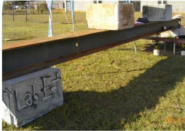
Figura 3.35 – Vigas e blocos de reação das provas de cargas.
