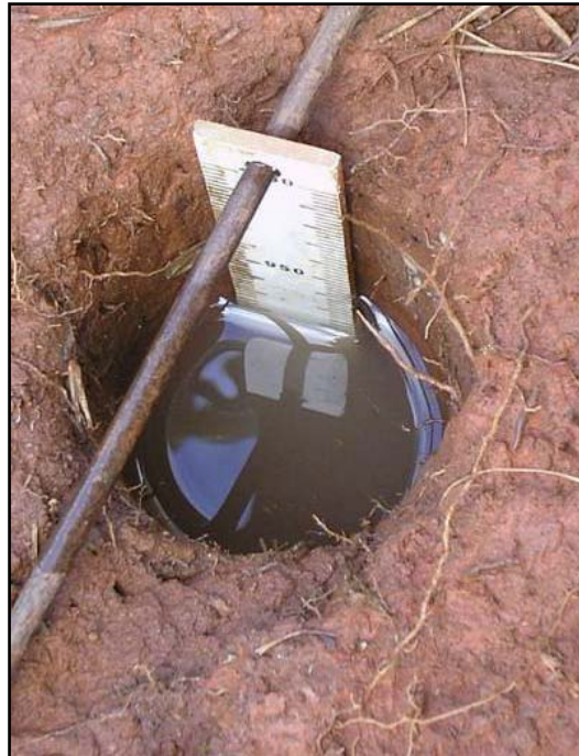
Figura 3.5 - Ensaio de rebaixamento em furo de sondagem a trado.
