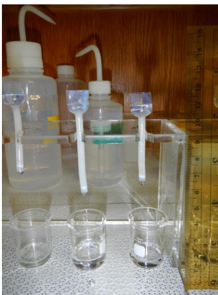
Figura 2.5: Foto de três sistemas cromatográficos: suporte, coluna de teflon e resina de troca catiônica na Universidade de Minnesota.
