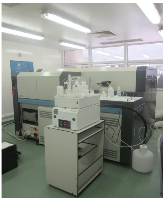
Figura 4.9: Foto do MC-ICP-MS Neptune acoplado ao micronebulizador Aridus II.
