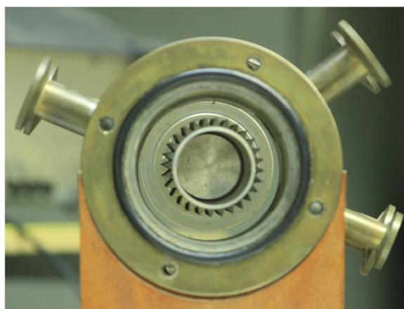
Figura 4.2 – Vista frontal da casca cilíndrica. A borracha preta é um anel de vedação colocado sobre a ranhura onde foram encaixadas as placas de Petri durante a validação microbiológica
