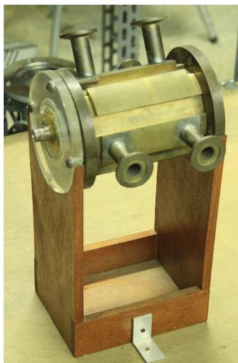
Figura 4.1 – Peça de latão sobre suporte de madeira com o eletrodo interno inserido.
