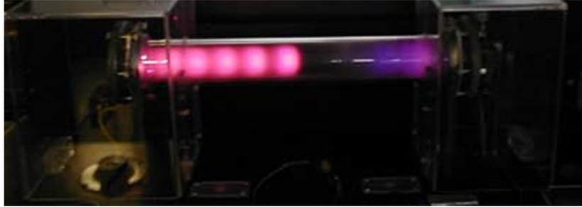
Figura 2.8 – Imagem de uma descarga luminescente.
