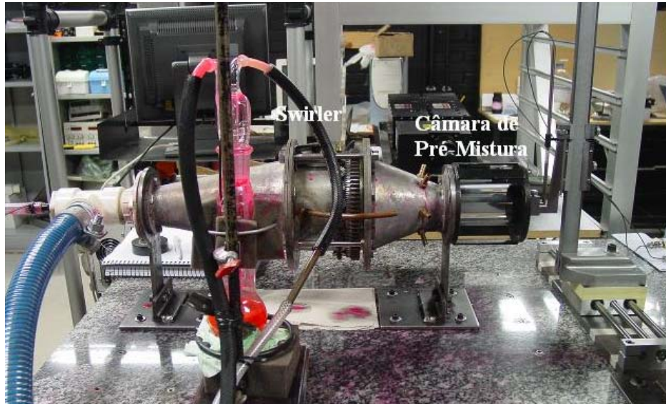
Figura 1.7 – Sistema Experimental; Swirler axial + Câmara de Pré-mistura do Combustor LPP.
