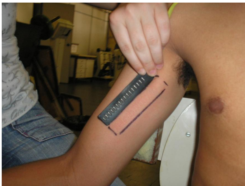
Figura 27 – Posicionamento do arranjo linear de eletrodos semi-flexível (seco) no bíceps braquial cabeça curta. Fonte: Dados da pesquisa.
