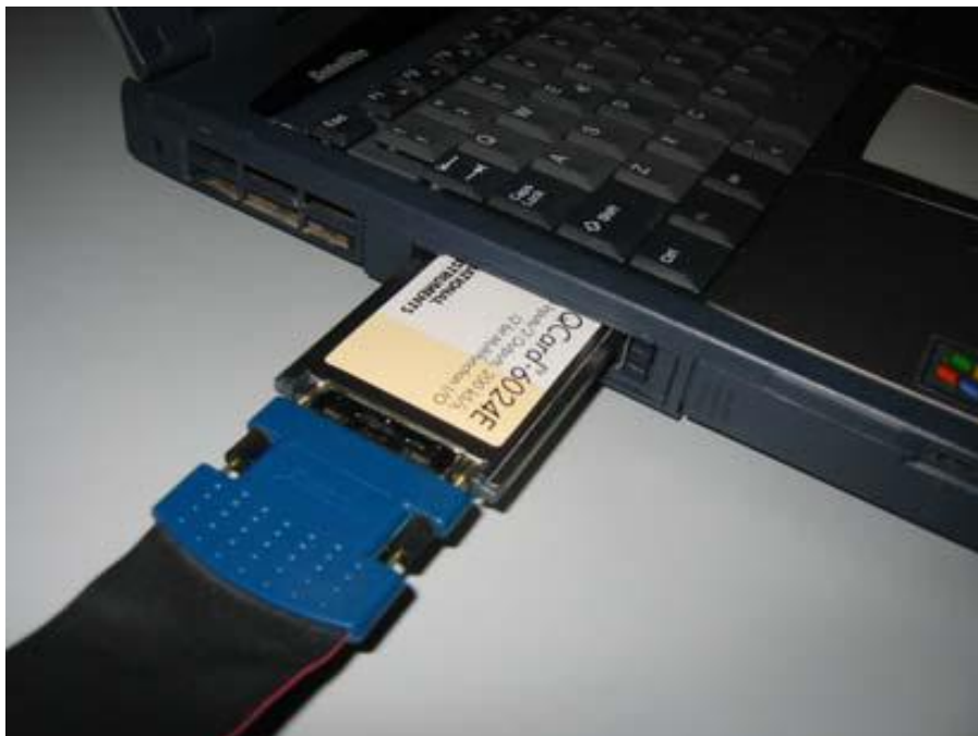
Figura 23 – Placa conversora analógico-digital de aquisição de dados PCMCIA. Fonte: Manual do equipamento.
