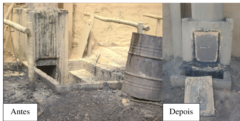
Figura 12: Depósito dos resíduos, alcatrão e ácido pirolenhoso, dos fornos RAC, antes e depois das modificações.
