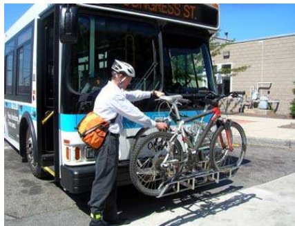
Figura 2.2 – Bicicleta Embarcada – Integração Ônibus e Bicicleta (Canadá)
