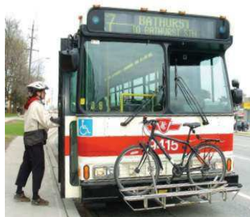
Figura 2.7 – Suporte para carregar bicicleta nos ônibus
