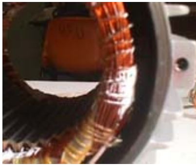
Figura 2.3 – Sensores térmicos instalados nas “cabeças de bobina” – Estator.
