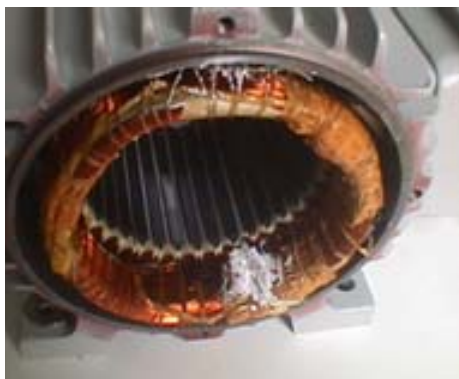
Figura 2.4 – Sensores térmicos instalados nas ranhuras do estator.
