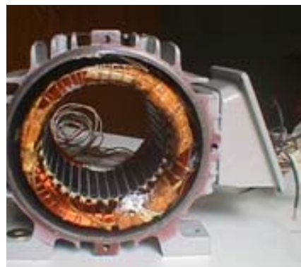
Figura 2.4 – Sensores térmicos instalados nas ranhuras do estator.
