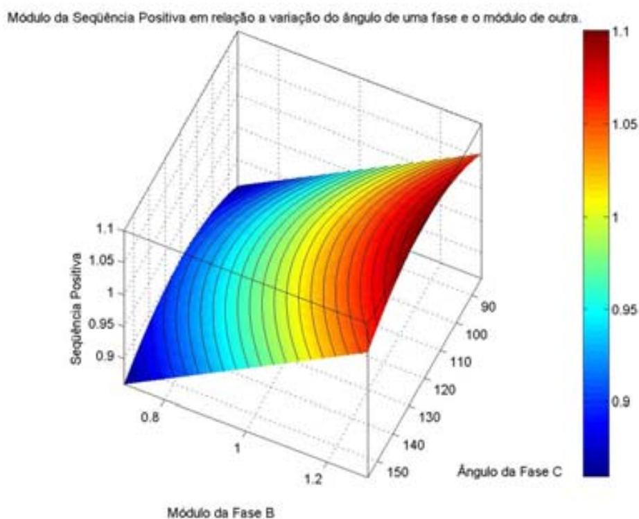
Figura A.27 - Comportamento dos módulos da componente positiva frente a variação da amplitude da tensão de uma fase com o ângulo de uma outra
