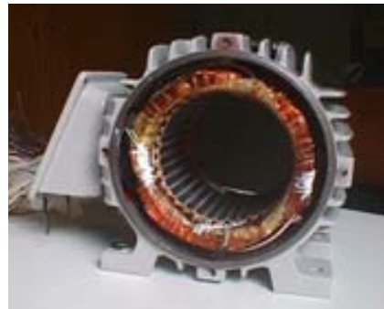
Figura 2.3 – Sensores térmicos instalados nas “cabeças de bobina” – Estator.
