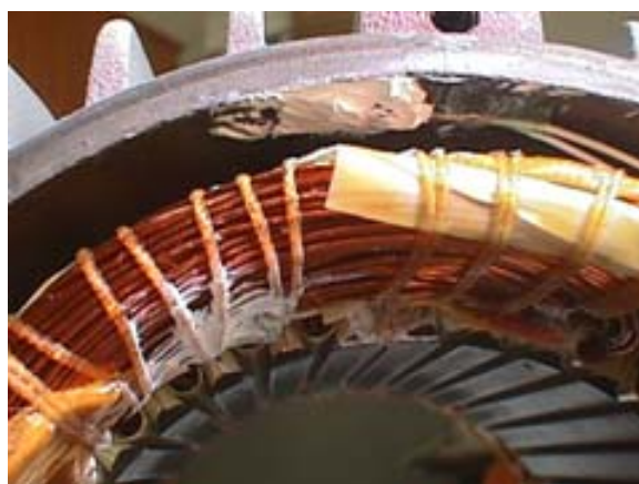
Figura 2.5 – Sensores térmicos instalados na carcaça.
