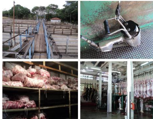
Figura 5 - Estrutura física do frigorífico: currais de espera; pistola de ar comprimido; túnel de congelamento de miúdos; trilhamento aéreo.
