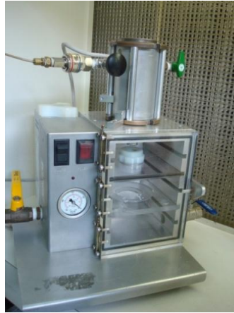
Figura 1.6. Equipamento de biobalística desenvolvido para acelerar micropartículas carreadoras de material genético. Para a aceleração dessas partículas é usada uma descarga de gás hélio, retido em alta pressão.
