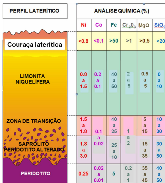
Figura 1 – Perfil laterítico idealizado a partir de protólito untramáfico (modified from Elias, 2002 and Golightly, 1981).
