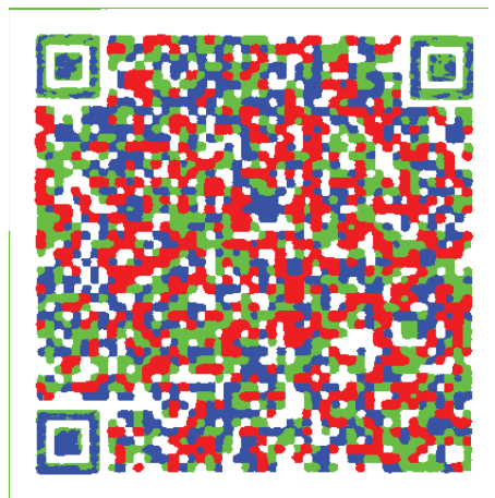
Figura 7.12: Processo de decodificação - Imagem limiarizada nas cores primárias de 3a na Tabela 7.1.
