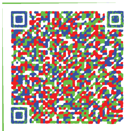
Figura 7.7: Processo de decodificação - Imagem limiarizada nas cores primárias de 1a na Tabela 7.1.
