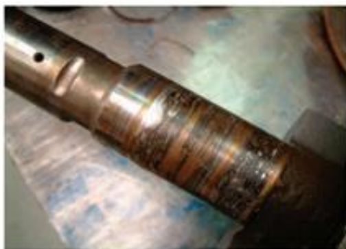
Figura 3.6 - Desgastes sofridos pelas peças móveis do compressor – Danfoss (2010).
