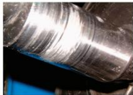
Figura 3.6 - Desgastes sofridos pelas peças móveis do compressor – Danfoss (2010).
