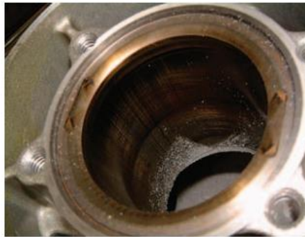
Figura 3.5 – Cavidade do cilindro, operando com deficiência de lubrificação – Danfoss (2010).
