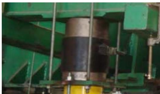
Figura 3.31 – Célula de carga empregada nas leituras de carga.
