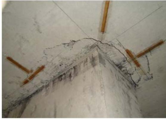
Figura 3.22 – Disposição dos extensômetros durante o ensaio.
