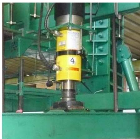
Figura 3.26 – Cilindro hidráulico de aplicação de cargas.
