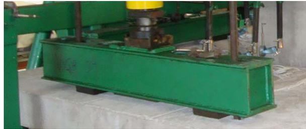
Figura 3.30 – Viga de distribuição da carga.
