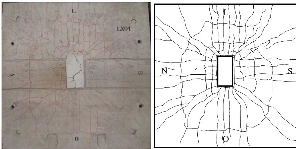
Figura 4.124 – Padrão de fissuração da laje LN01.
