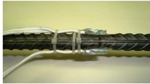
(b) Proteção com resina epóxi
