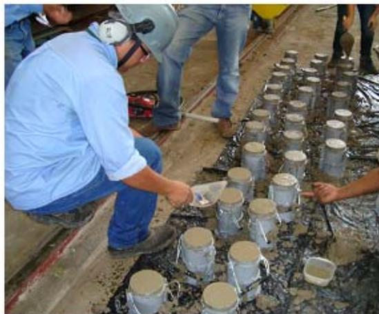
Figura 3.14 – Moldagem dos corpos de prova.
