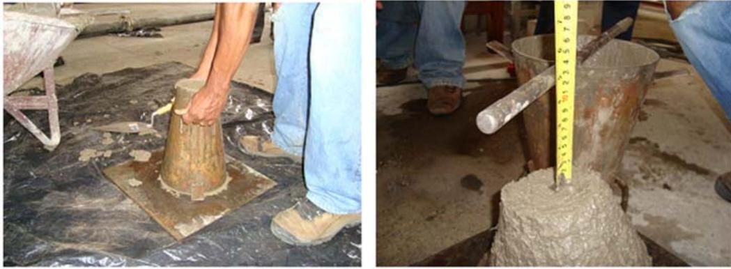
Figura 3.13 – Teste de abatimento do tronco de cone.
