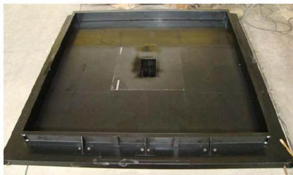
Figura 3.11 – Fôrma pronta para receber a armadura.
