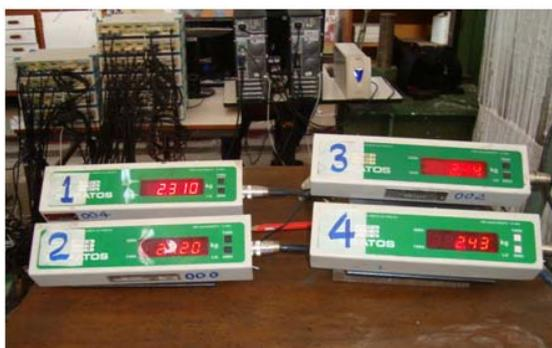
Figura 3.32 – Indicadores para acompanhamento dos passos de carga durante ensaio.
