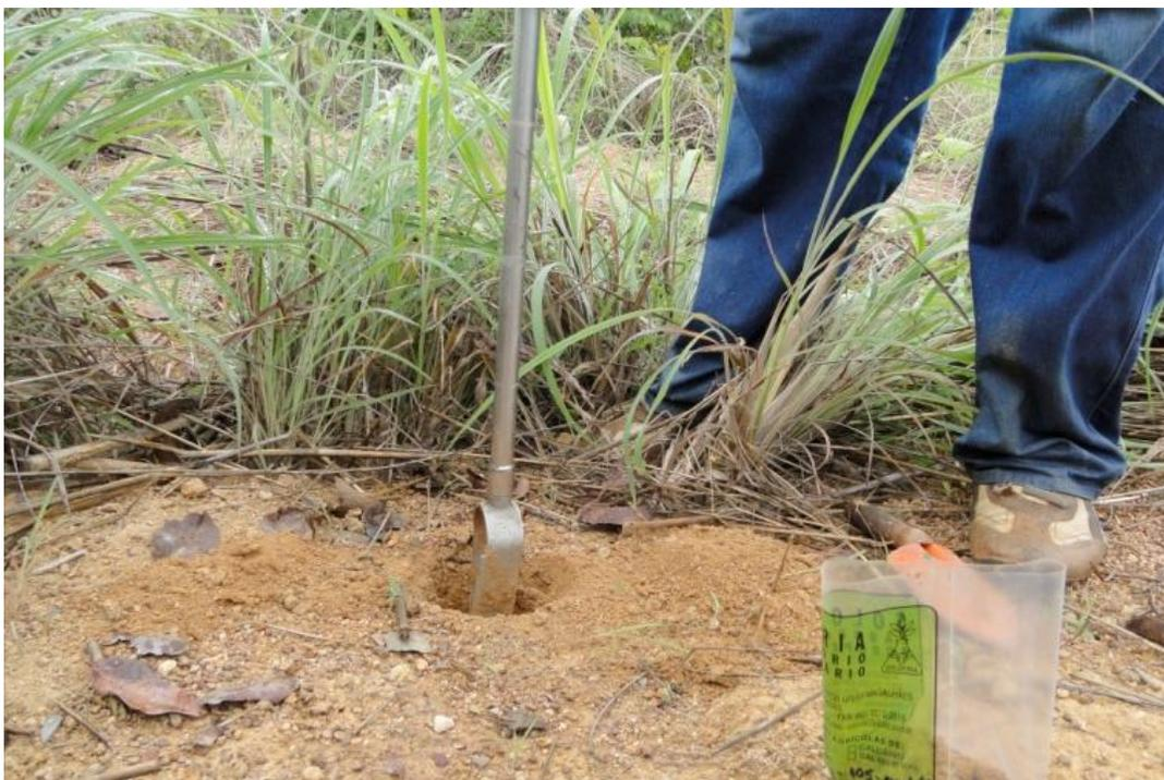
Figura 5.14 - Coleta de amostras de solos a profundidade de 0 – 20 cm. Foto: Michelle Carmelinda Pegorini Bordini.
