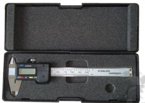
Figura 5.12 - Modelo do paquímetro digital utilizado para obtenção dos diâmetros das plantas.
