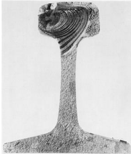
Figura 2.4. Macrografia de um trilho de trem que falhou por fadiga (fonte: ASM Metals Handbook- Fractography, 1987)
