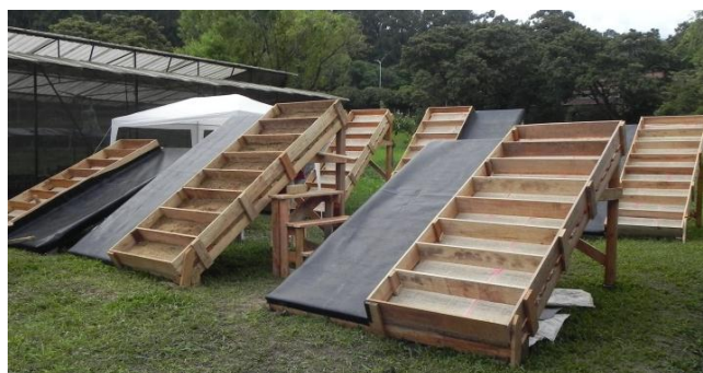
Figura 4.62 Parcelas-modelo utilizadas para avaliar a retenção de solo sobre a cobertura dos taludes.
