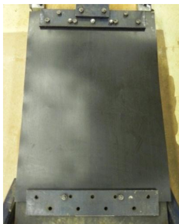
Figura 3.10 Geomembrana de PEAD lisa fixada pelas garras colocadas sobre a rampa.
