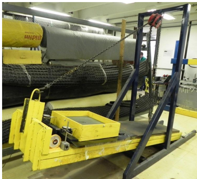
Figura 3.2 Equipamento de plano inclinado utilizado nos ensaios, localizado na Universidade de Brasília.
