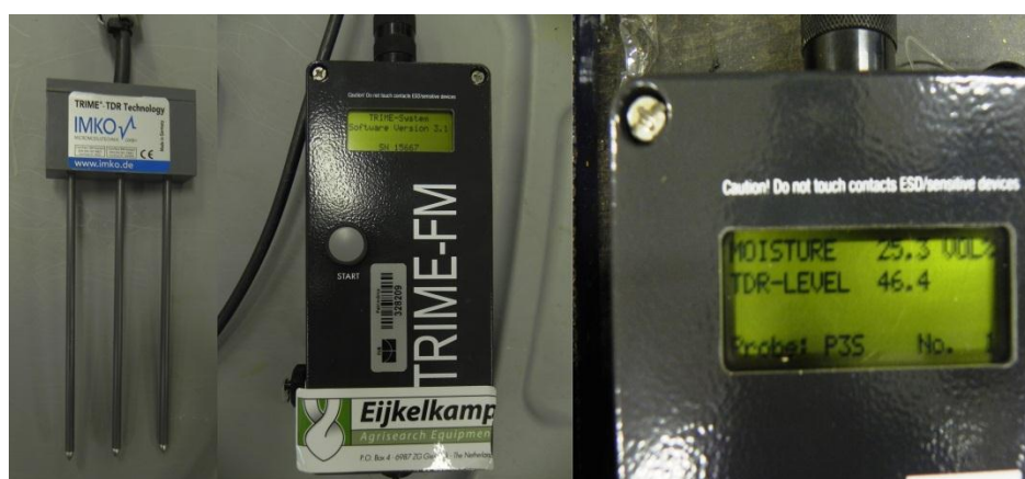
Figura 3.6 Equipamento TDR para a medição de umidade volumétrica do solo.
