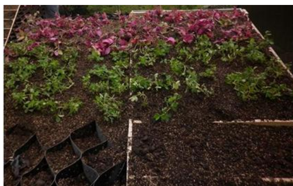
Figura 4.63 Estabelecimento da vegetação e erosão do solo sobre as parcelas-modelo com inclinação de 25° (Pinzon, no prelo 2012).
