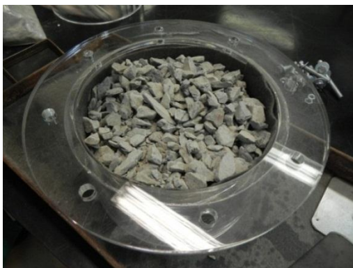
Figura 3.18 Tubo inferior do equipamento preenchido com brita.
