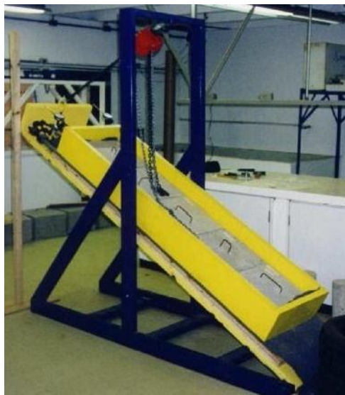
Figura 2.21 Equipamento de plano inclinado da Universidade de Brasília (Lima Júnior, 2000).
