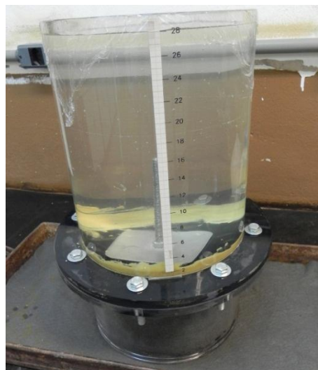
Figura 3.20 Ensaio de percolação em andamento.
