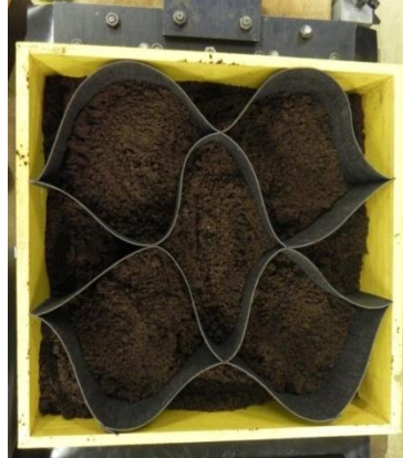
Figura 3.11 Preparação da interface do ensaio, com a geocélula e o solo sendo depositado dentro da caixa de confinamento sobre a geomembrana.
