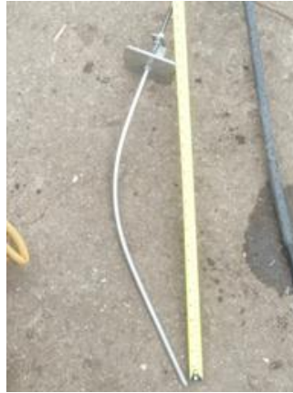
Figura 3.24 Imagem do grampo deformado após a realização do ensaio.
