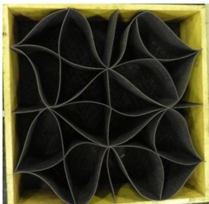
Figura 3.14 Configuração da geocélula com retalhos utilizada nos ensaios de interface solo-geocélula com retalhos/geomembrana.
