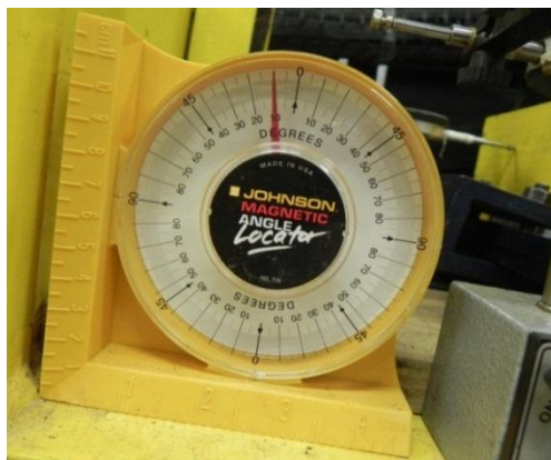
Figura 3.5 Medidor de ângulo instalado sobre a rampa.
