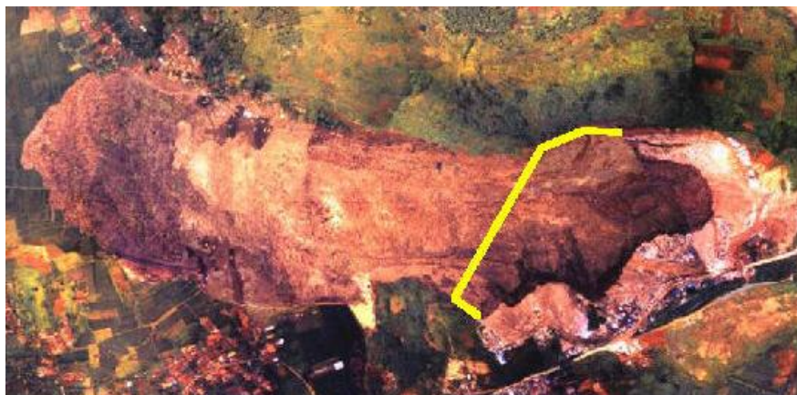
Figura 2.4 Vista aérea do deslizamento do aterro Leuwigajah na Indonésia em 2005 (Koelsch et al. , 2005).
