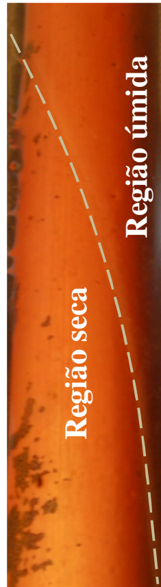
Figura 5.19. Foto do tubo de cobre do absorvedor, com indicação do filme estabelecido, para uma vazão de solução de 50 l/h.
