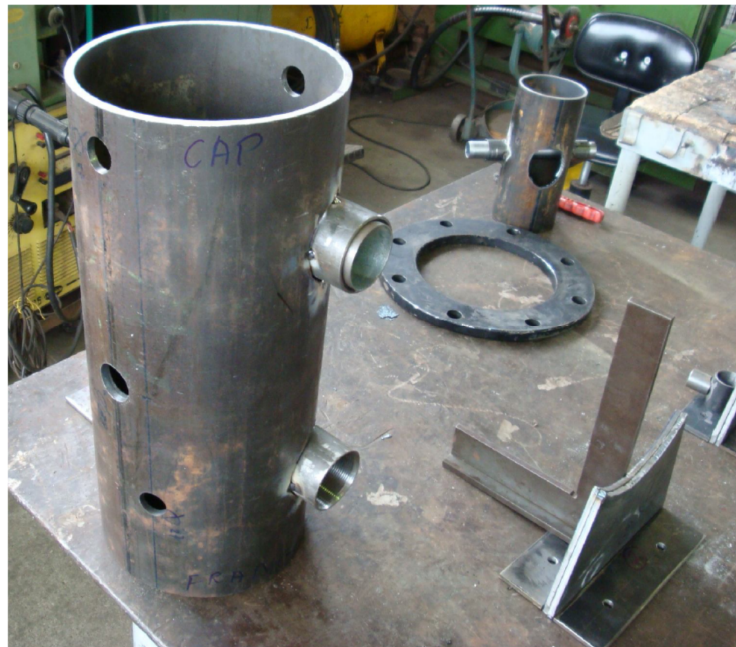
Figura 4.12. Gerador e evaporador durante fabricação.
