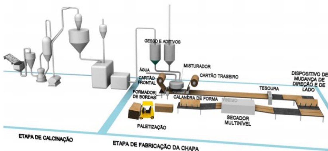
Figura 3.11 - Processo de produção de das chapas de gesso acartonado.
