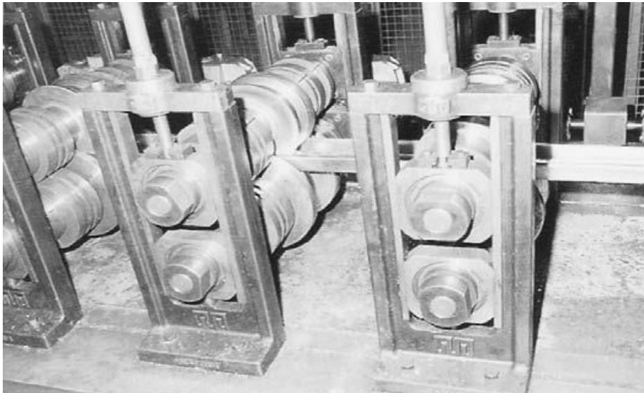
Figura 3.6 - Fabricação por perfilagem de perfis em “U”. Fonte: CRASTO e FREITAS, 2006.
