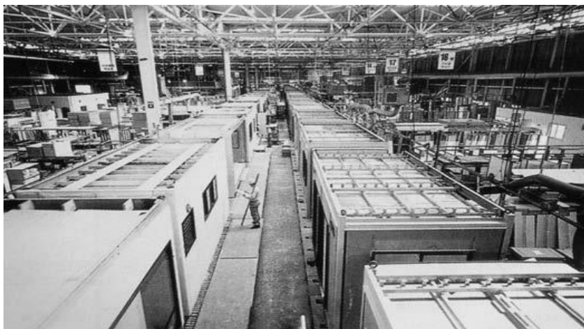
Figura 3.2 - Linha de montagem de módulos residenciais no Japão. Fonte: CRASTO e FREITAS, 2006.
