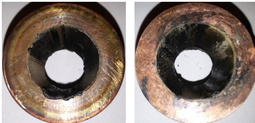
Figura 4-24- Fotos do convergente (esquerda) e divergente (direita) do bocal B4a-1 após o primeiro teste.
