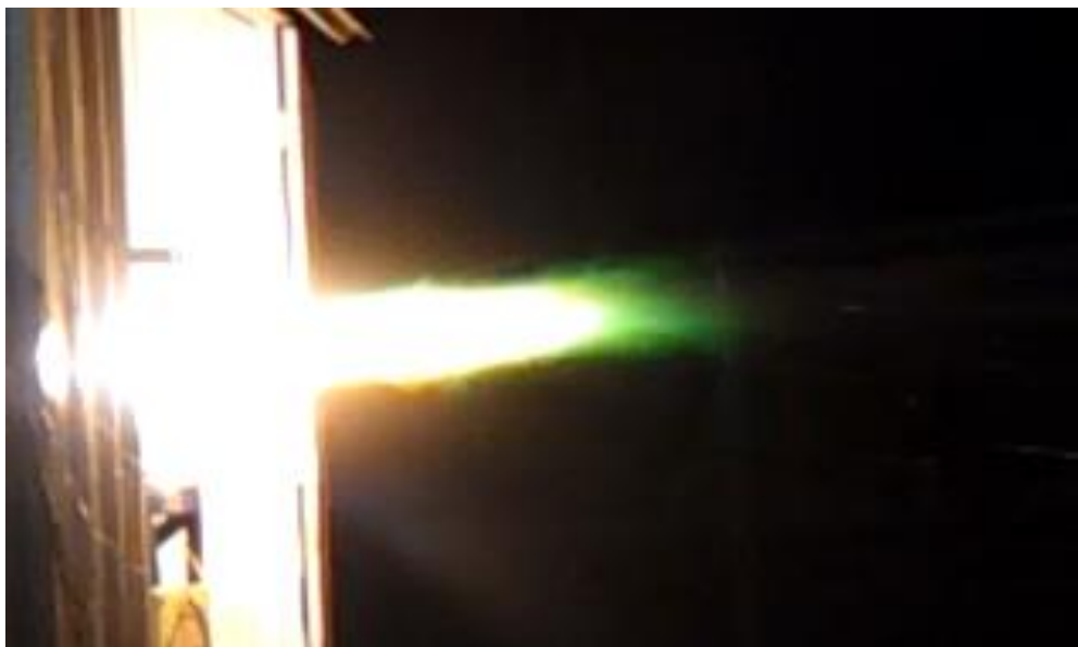
Figura 4-8 - Foto do momento em que a chama do teste de 13 segundos com o bocal B4 (CuCr sem revestimento) apresenta coloração esverdeada, indicando a fusão do material do bocal.
