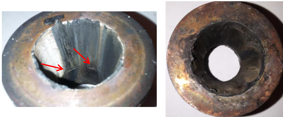
Figura 4-25- Fotos do bocal B4a-1 mostrando o desgaste na garganta vista pelo convergente (esquerda) e o acúmulo de material no divergente (direita).
