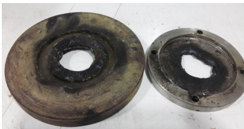
Figura 3-20 – Tampa de Celeron e o flange de aço inox substituídos após o 12º teste.
