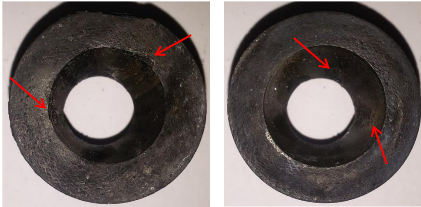
Figura 4-14 – Fotos do convergente (esquerda) e divergente (direita) da tubeira B2a-1.
