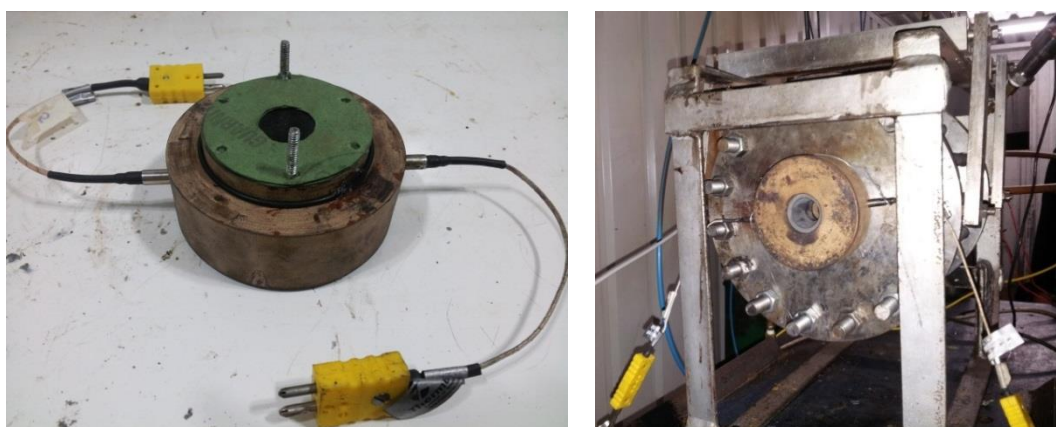
Figura 3-6 – Fotos da montagem da câmara de fixação da tubeira com os termopares.
