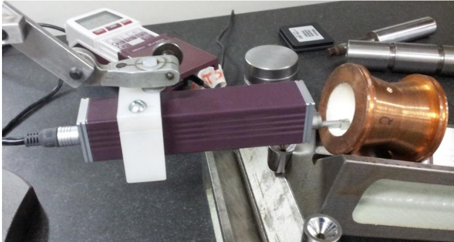
Figura 3-13- Rugosímetro para a medida da rugosidade média das tubeiras.
