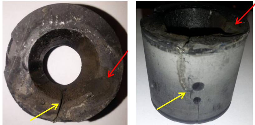
Figura 4-11- Fotos do bocal B1-2 após o teste aonde é possível visualizar a trinca na seção longitudinal do bocal.
