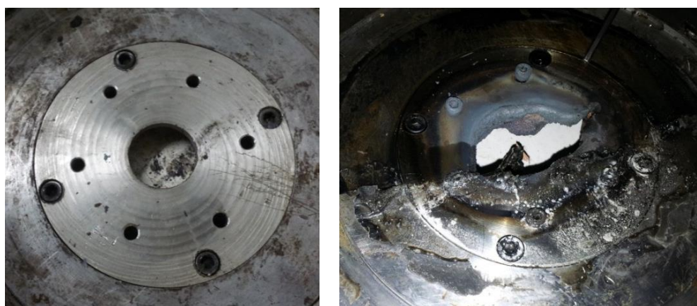
Figura 3-17 – Fotos do flange de inox antes e após o teste, podendo observar o desgaste devido a agressividade da queima.
