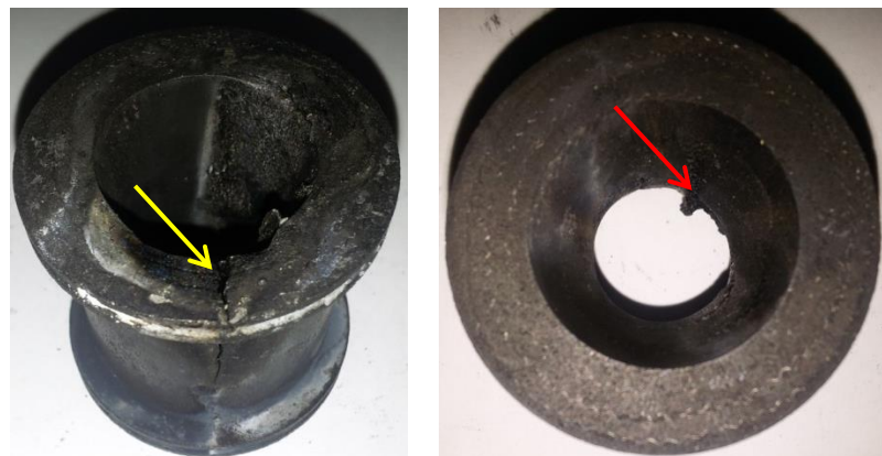
Figura 4-17 – Convergente (esquerda) e divergente (direita) da tubeira B3-2.
