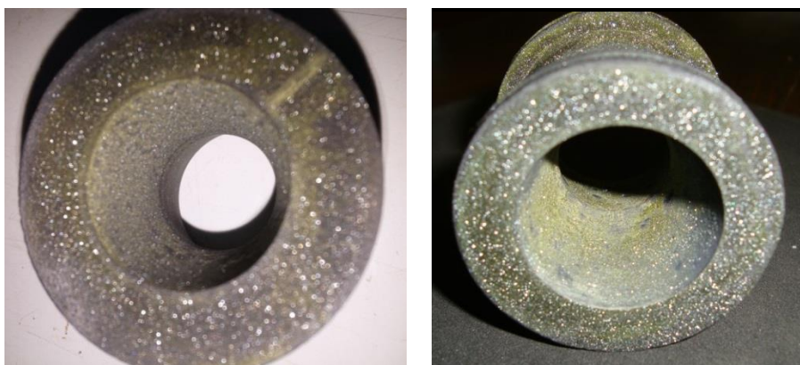
Figura 4-2 – Revestimento nos bocais B2a (esquerda) e B3a (direita).
