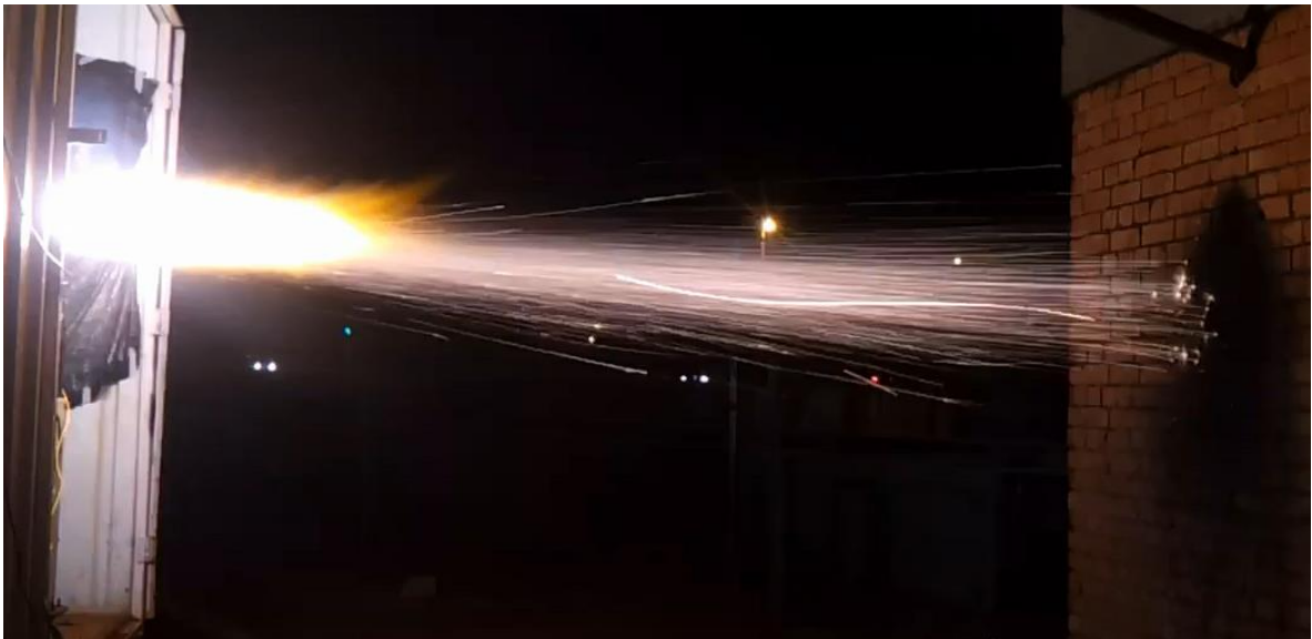
Figura 4-7- Teste com o bocal B3-2 com 5,2 segundos de duração, aonde são observados uma grande quantidade de partículas metálicas sendo ejetadas durante a queima do grão.
