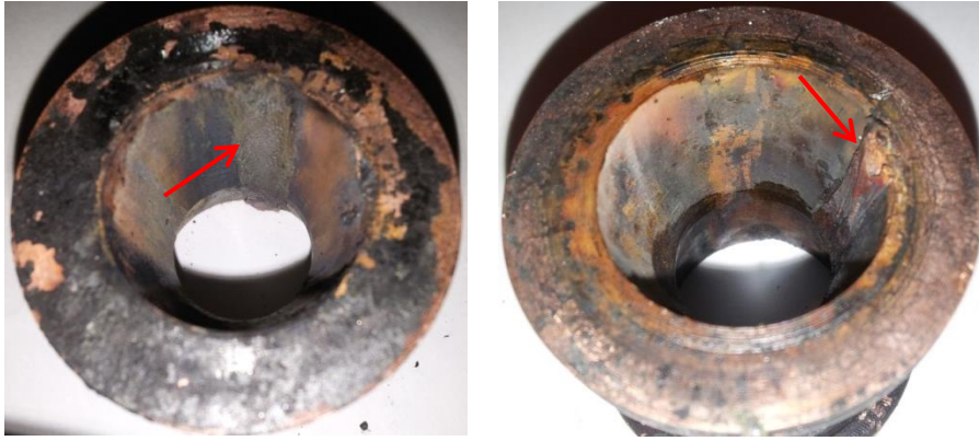
Figura 4-23 – Bocal B4 após o segundo teste de 13 segundos mostrando a região de fusão do material no convergente (esquerda) e divergente (direita).
