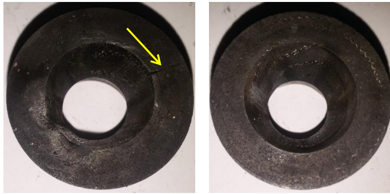
Figura 4-19 – Convergente (esquerda) e divergente (direita) da tubeira B3-1.
