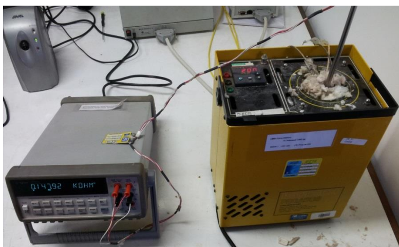
Figura 3-15 – Sistema montado para a calibração dos termopares.
