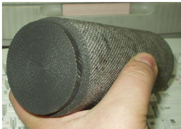
Figura 3-11 - Pré-forma de CCCM com tecido de fibra de carbono.
