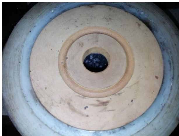
Figura 3-19 – Tampa de Celeron encaixada no final do grão para proteção do flange.
