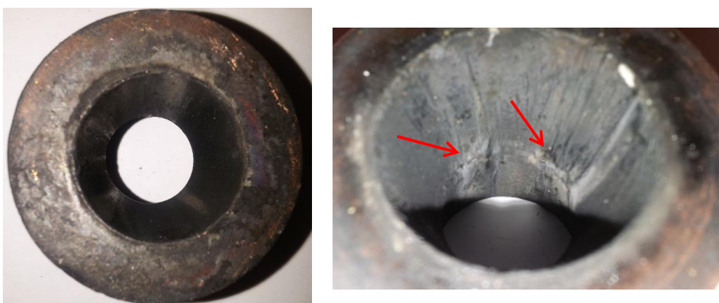
Figura 4-28- Foto da seção convergente (esquerda) e dos pontos de desgastes do revestimento (direita).
