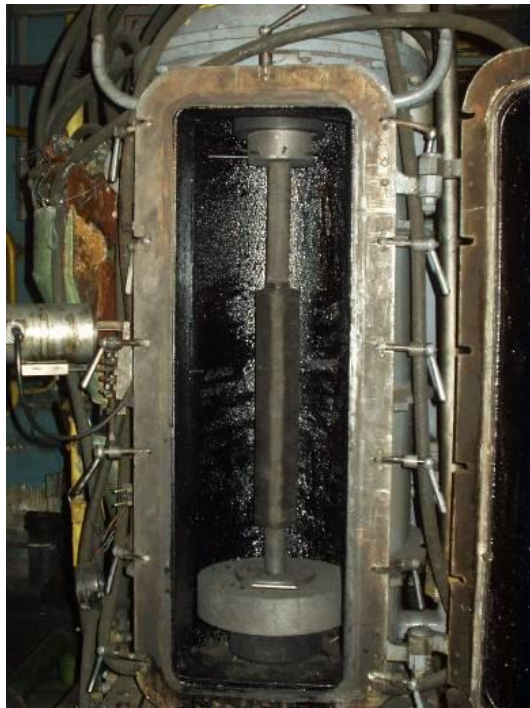
Figura 3-10 – Aparência original da pré-forma dentro da câmara da AGATE-1.6.
