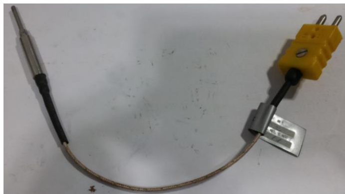
Figura 3-14 – Foto do termopar utilizado no monitoramento da temperatura do bocal.
