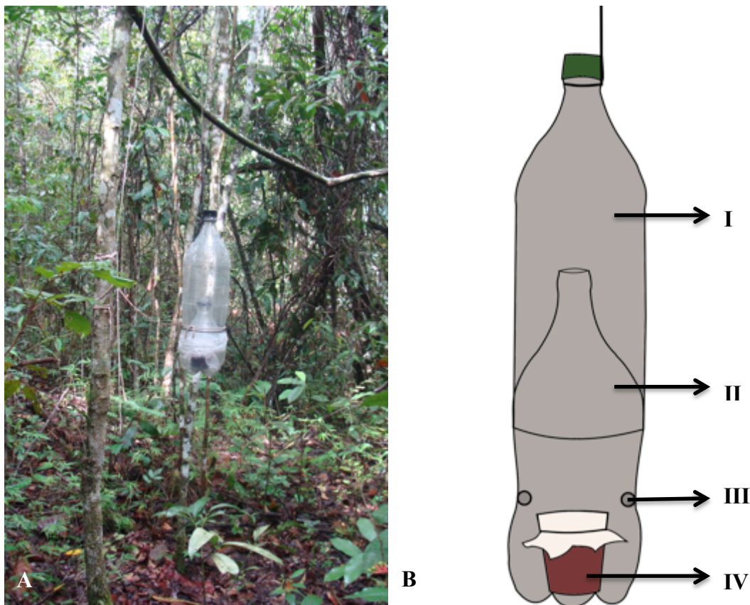
Figura 5. Armadilha PET. (A) - Disposição das armadilhas no campo. (B) - Esquema de montagem da armadilha. (I) - Câmara de coleta; (II) - Funil; (III) - Abertura que permite a entrada dos dípteros; (IV) - Pote plástico contendo a isca coberto por voal.
