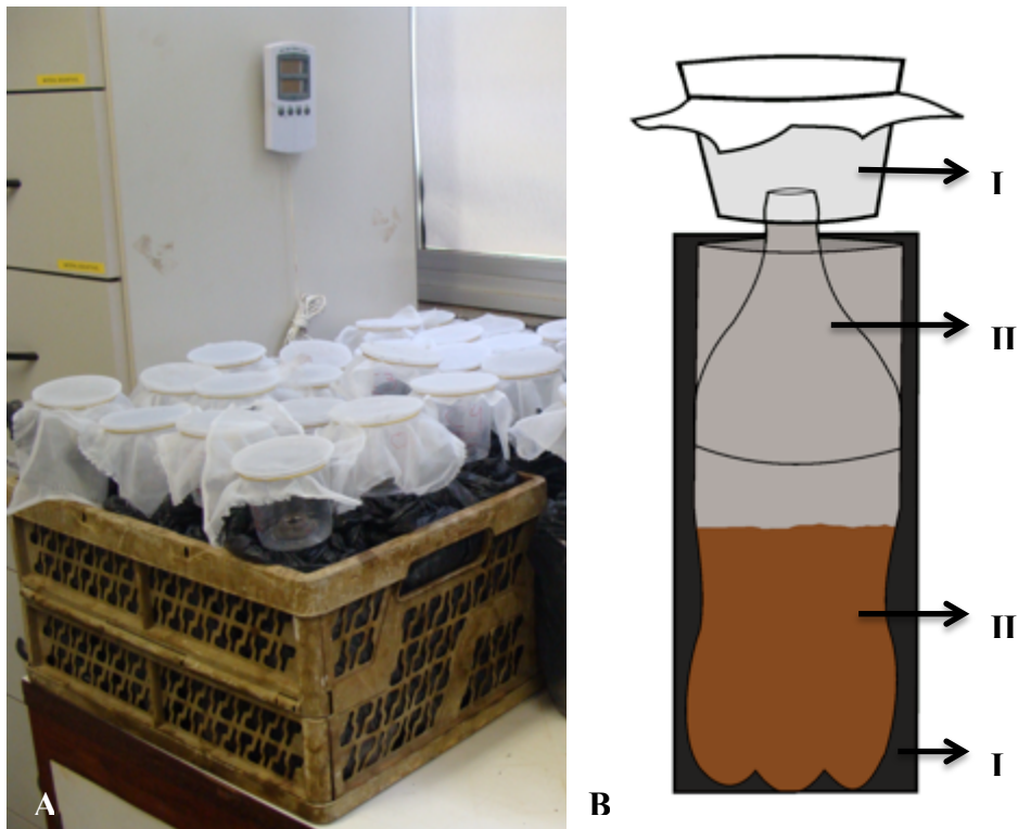
Figura 7. Armadilha de emersão em laboratório. (A) – Armadilhas no período de coleta dos espécimes emergindo no laboratório. (B) – esquema de montagem da armadilha. (I) – Pote coletor coberto por voal; (II) – Funil que separa a câmara de emersão do pote coletor; (III) – Terra com a isca enterrada; (IV) – Saco preto para barrar a entrada de luz.
