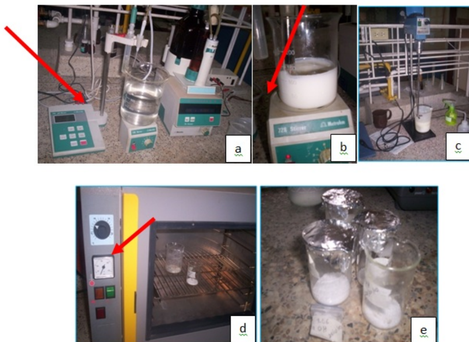
FIGURA 2.1: As fotografias mostram as diferentes etapas de síntese de ZnO pelo método de precipitação controlada. (a) Início da adição de hidróxido de amónio, (b) processo intermediário, (c) lavagem da amostra, (d) tratamento térmico, (e) ZnO em pó.
