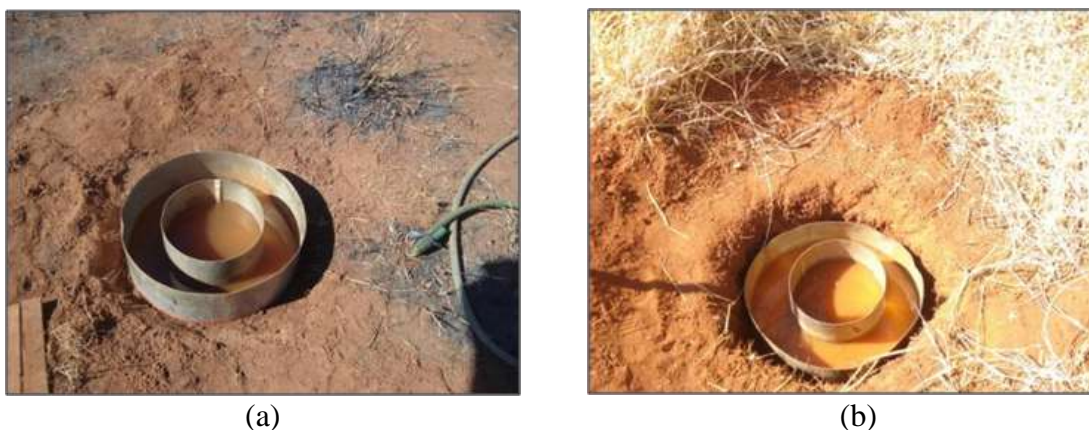
Figura 3.9 – Ensaio de infiltração com o infiltrômetro cilindro concêntrico: (a) Poço 3 em 0,1 m ; (b) Poço 8, em 0,3 m, respectivamente, nas regiões norte e sul de Goiânia-GO.
