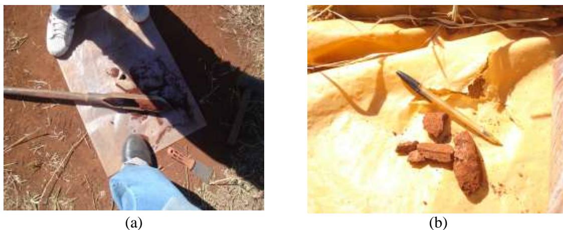
Figura 6.29 – Coleta de material realizada em agosto-setembro/2010 para obtenção do \gamma_n (método não convencional): (a) Poço 2 em 0,5 m e (b) Poço 8 em 2 m.
