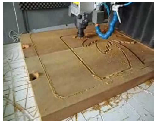
Figura 1. Prototipagem por subtração em montagem de modelo em escala reduzida. Fonte: http://www.veengle.com
