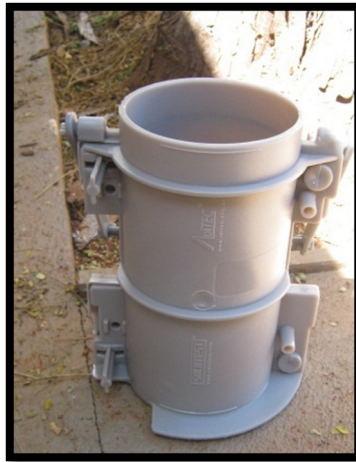
Figura 80: Corpo-de-prova 10x20 cm. Fonte: Foto da Autora.
