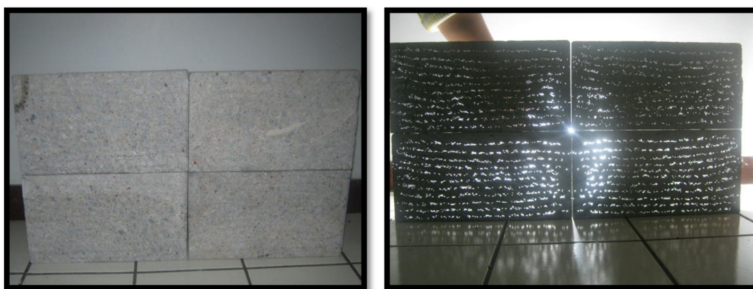
Figura 112: Painel de concreto com fibra ótica.
