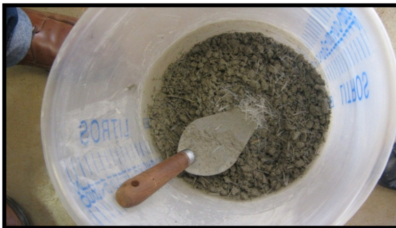
Figura 116: Resultado da mistura de concreto com fibra ótica.
