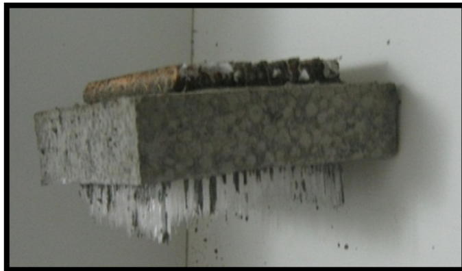
Figura 98: Painel de concreto com fibras à vista e guias de madeira.
