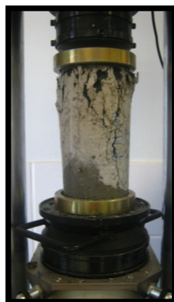
Figura 83: Rompimento de corpos-de-prova, ensaio de resistência à compressão. Fonte: Foto da Autora.
