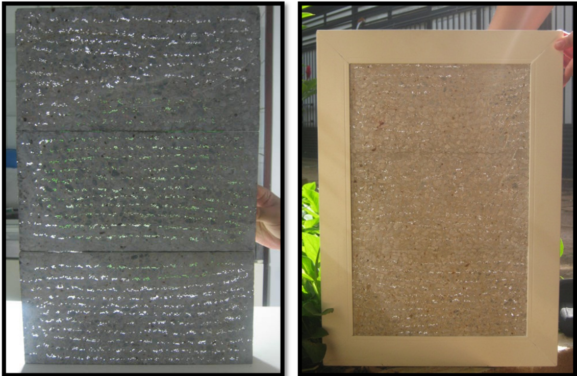
Figura 113: Painel final de concreto com fibra ótica.
