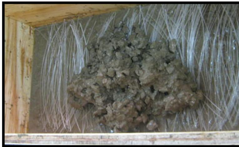
Figura 103: Fibras óticas e argamassa colocada uma acima da outra.
