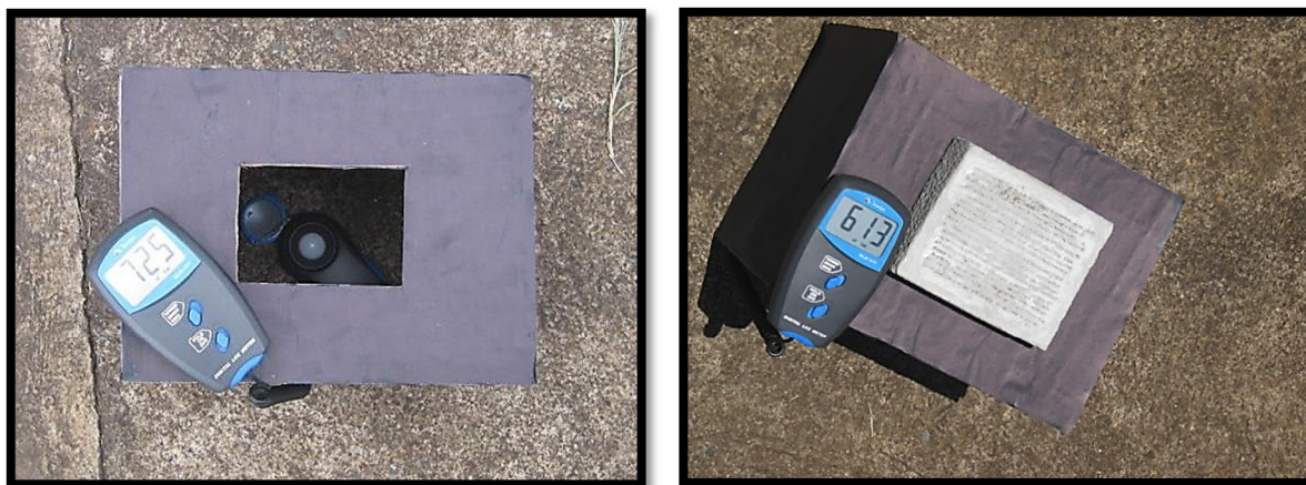
Figura 122: Caixa preta com luxímetro para medir a intensidade luminosa.
