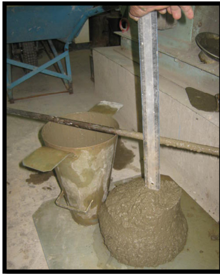
Figura 79: Ensaio de Abatimento cone de Abrams.
