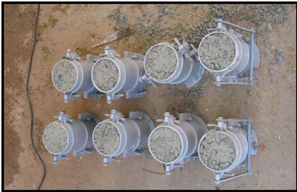
Figura 81: Moldagem de Corpos-de-prova. Fonte: Foto da Autora.
