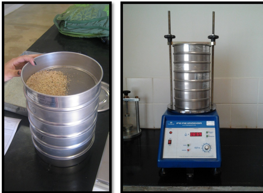
Figura 73: Peneiras para a determinação da granulometria do agregado. Agitação manual e mecânica.
