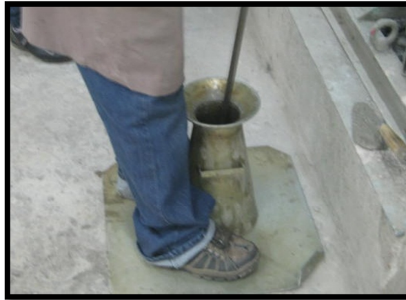
Figura 78: Abatimento no cone de Abrams, preenchimento em três camadas.
