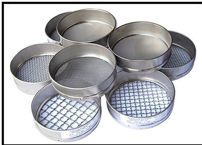
Figura 126: peneiras para determinar o tamanho do agregado.
