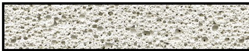
Figura 17: Concreto para isolamento térmico e acústico.
