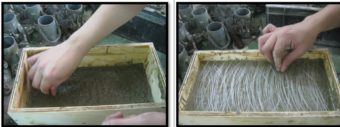
Figura 109: Forma de madeira com camadas de concreto e fibra ótica.
