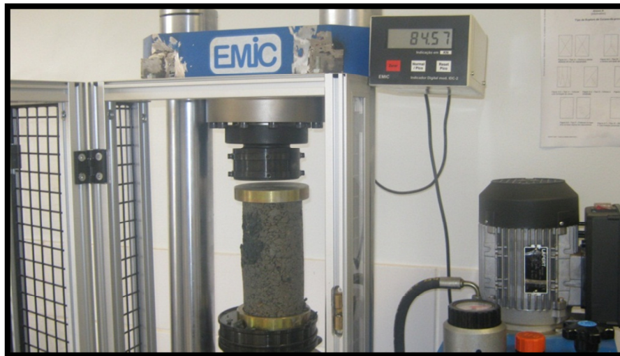
Figura 84: Ruptura de corpos-de-prova para ensaio de resistência à compressão. Fonte: Foto da Autora.
