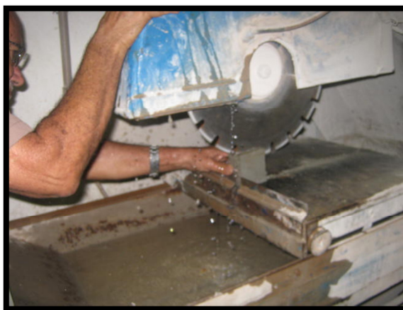
Figura 105: Bloco de concreto com fibra ótica sendo cortado. Fonte: Foto da Autora.
