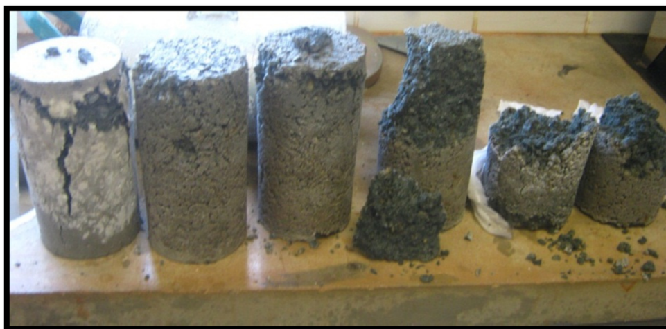
Figura 117: Corpos de prova, ensaio de resistência à compressão.
