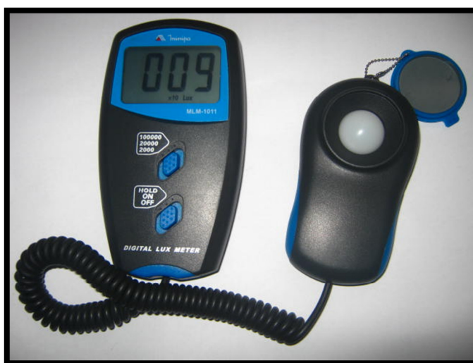
Figura 85: Luxímetro Digital MLM-1011, Minipa. Fonte: Foto da Autora.
