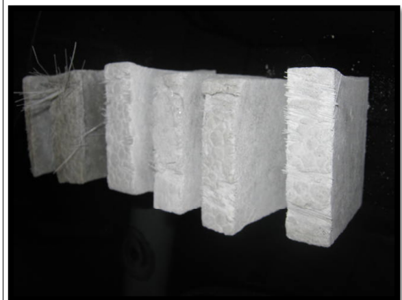
Figura 105: Bloco de concreto com fibra ótica sendo cortado. Fonte: Foto da Autora.
