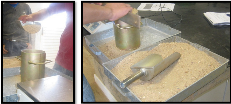
Figura 69: Determinação da massa unitária de agregados no estado solto. Fonte: Foto da Autora.
