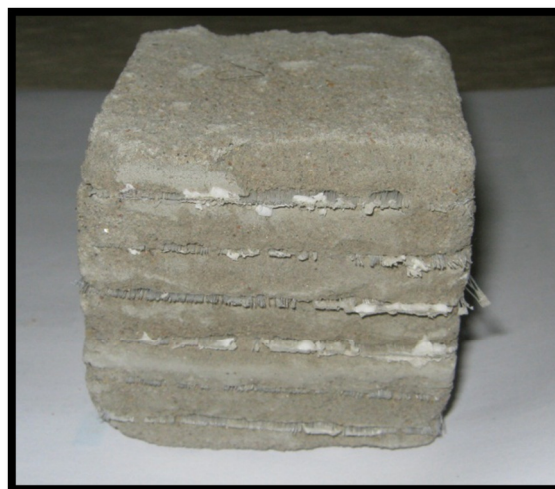
Figura 92: Bloco de concreto com fibras óticas.
