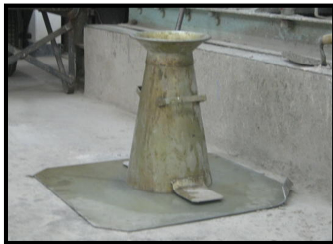
Figura 77: Cone de Abrams, ensaio de abatimento.
