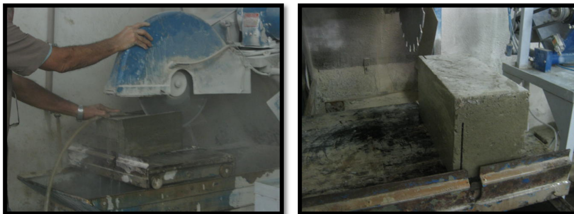
Figura 111: Corte do bloco com fibras óticas em placas.
